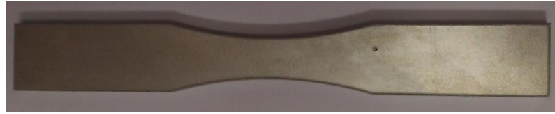
Şekil 5.1. Sac plakadan su jeti ile kesim ile numunelerin elde edilmesi
