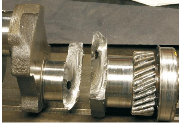
Şekil 4.1. Yorulma sonucu malzemede meydana gelen kopma [42]
