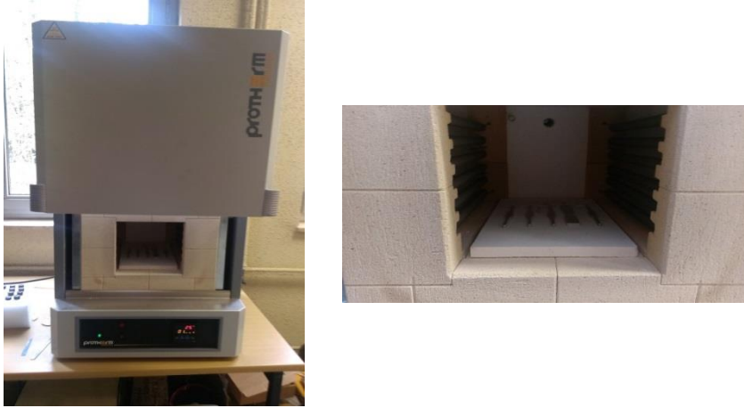
Şekil 5.6. Protherm PLF 130/25 kamara ısıtım işlem fırını
