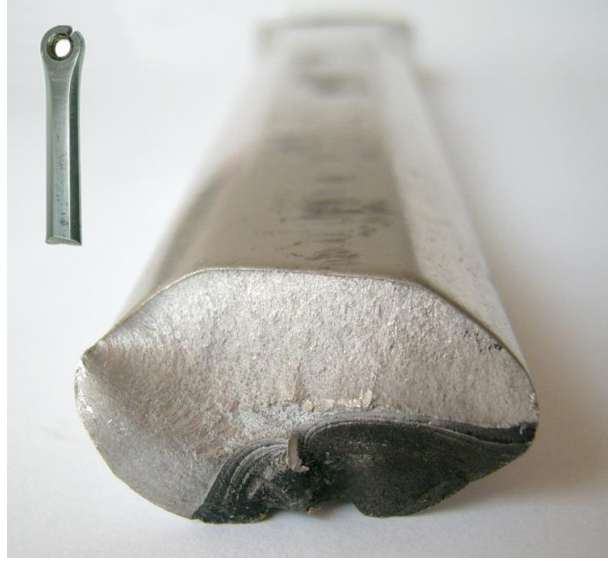
Şekil 4.4. Bir alüminyum çubuğun çatlaması. Siyah alan zamanla büyüyen çatlaktır. Beyaz parlak alan ise bir anda kopma nedeniyle oluşmuş çatlaktır
