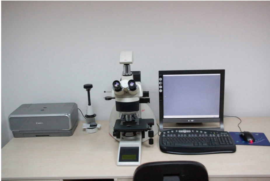
Resim 3.7. Mikroyapıların görüntülenmesinde kullanılan optik mikroskop.
