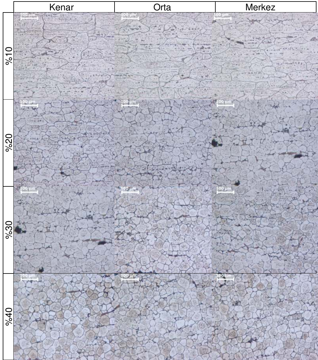
Resim 4.6. 600 °C'de AA2024 alaşımda soğuk deformasyon oranına bağlı mikroyapı değişimi
