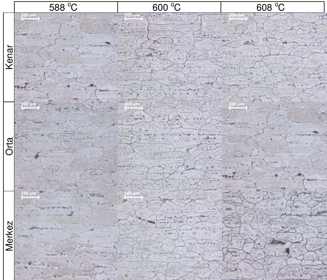
Resim 4.8. %10 soğuk deformasyon uygulanmış AA2024 alaşımında sıcaklığa bağlı mikroyapı değişimi
