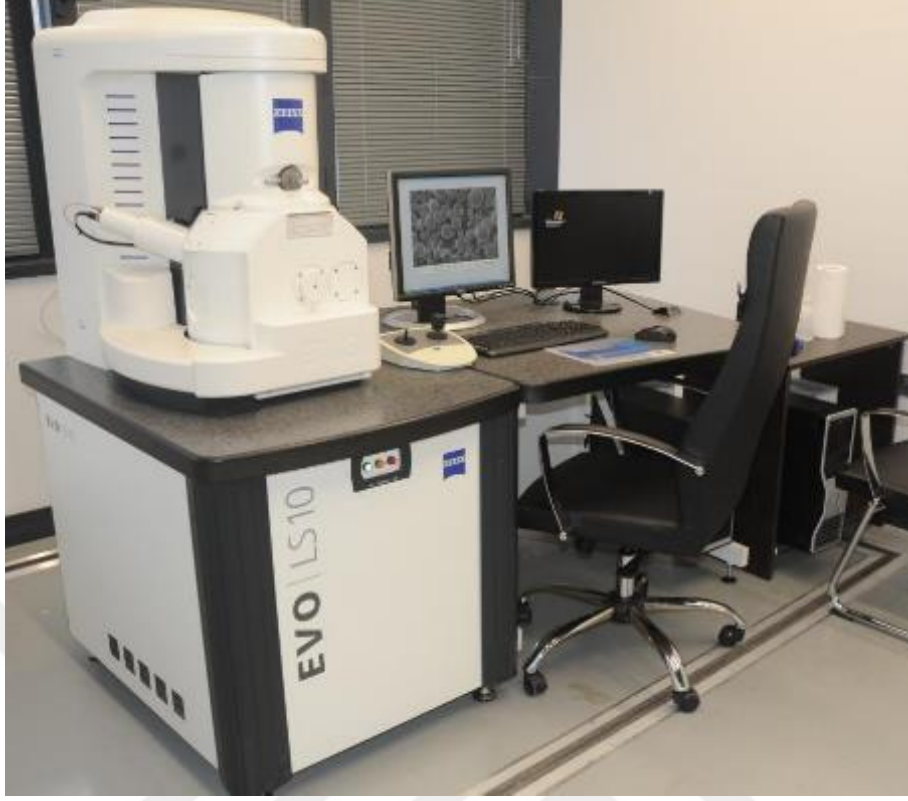
Şekil 2.9. Mikroskobik incelemeler için kullanılan SEM/EDS cihazı
