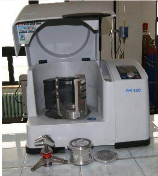
Şekil 2.3. Mekanik öğütme işlemi için kullanılan gezegen tipi bilyalı değirmen
