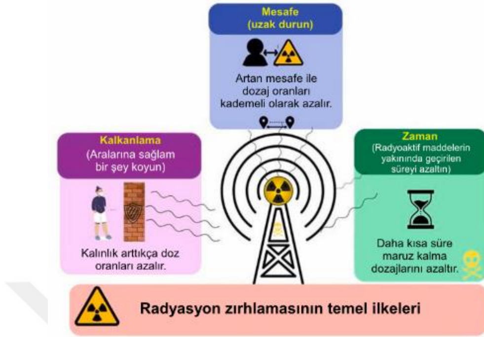
Şekil 1.7. Radyasyon zırhlamasının temel ilkeleri (Onaizi vd., 2024)
