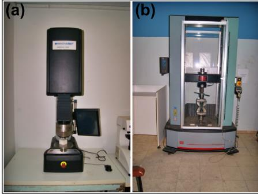
Şekil 2.11. Mekanik deneyler için kullanılan cihazlar; (a) sertlik ve (b) çekme cihazları
