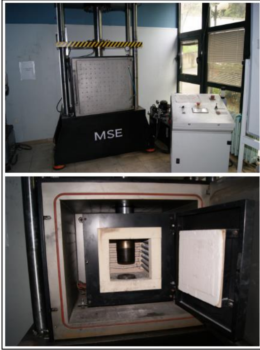
Şekil 2.4. AA2024/B 4 C kompozit FDM'lerin üretildiği sıcak pres cihazı
