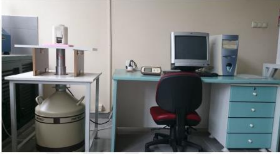
Şekil 2.18. Gama soğurma spektrometresi
