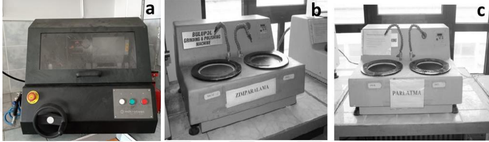
Şekil 16. Kesme (a), zımparalama (b) ve parlatma makinaları (c)
