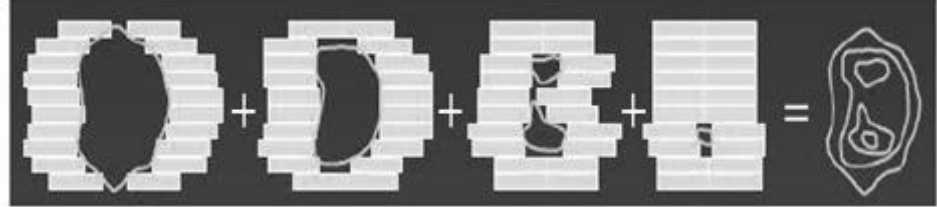
Şekil 2.5: Step and Shoot IMRT tekniğinin şematik gösterimi
