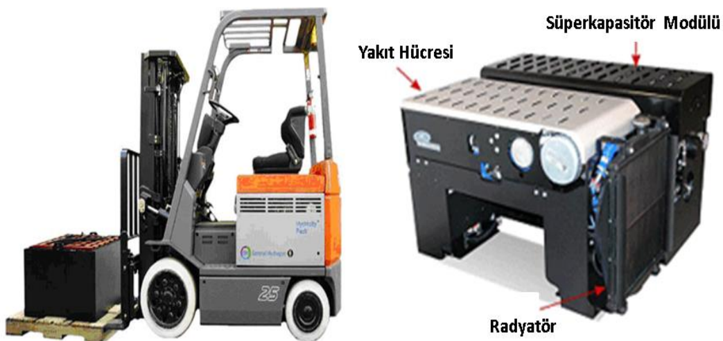
Şekil 2.6 : Forkliftlerde kullanılan yakıt hücresi/süperkapasitör sistemi [13].
