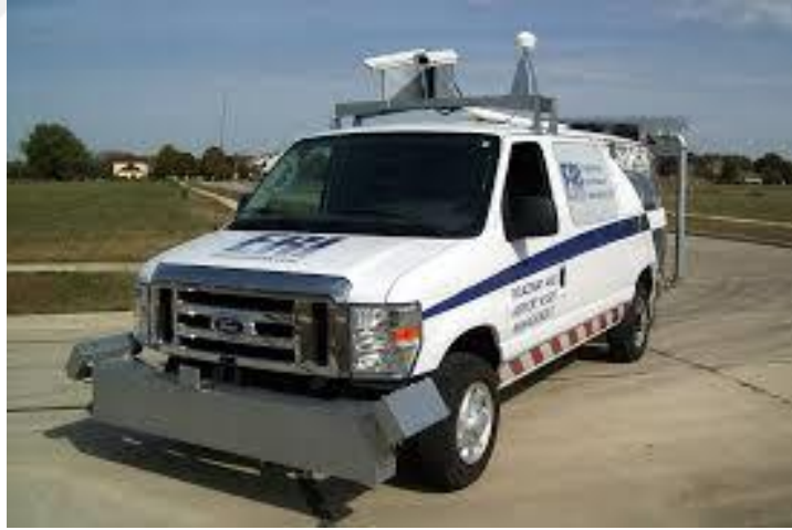
Şekil 1.2. IRI ölçümünde kullanılan profilometre
