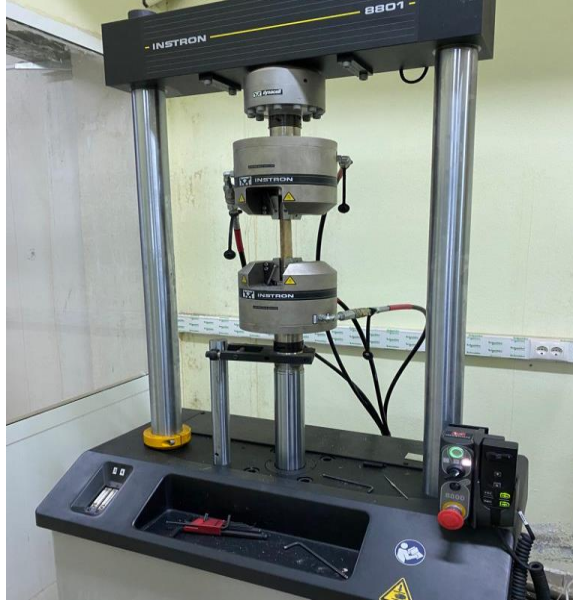
Şekil 3.4 INSTRON 8801 statik çekme cihazı
