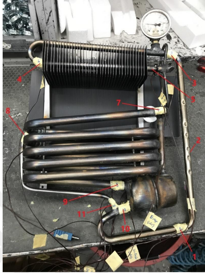
Şekil 3.5. ASS'nin sıcaklık ölçüm noktaları ve manometre bağlantısı.
