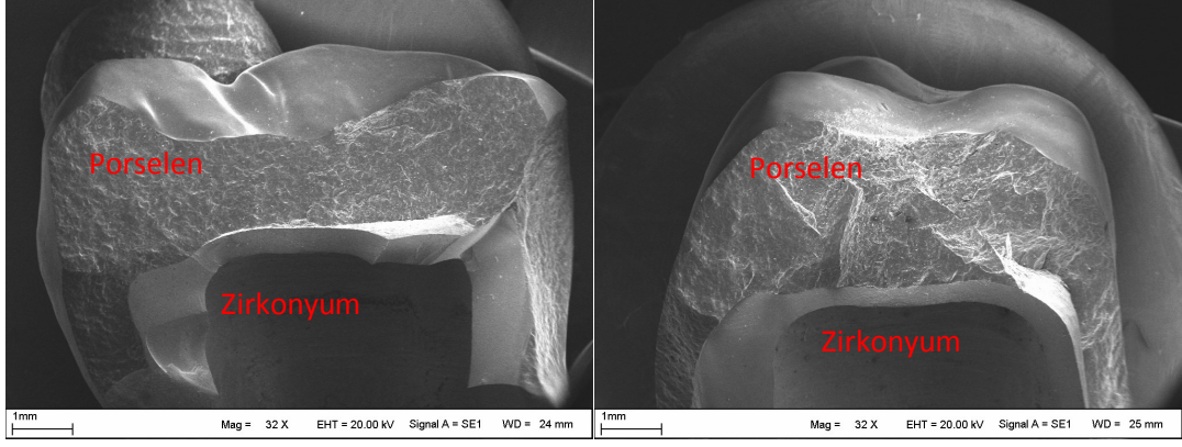
Resim 47: Kırılma Tipi III. Hem veneer porseleni hem de altyapıyı içine alan katastrofik kırılma
