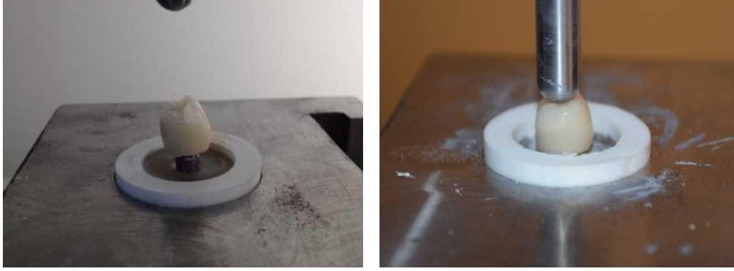
Resim 38: Tip I Kırılma. Sadece veneer porselenin iç yüzeyinde ortaya çıkan koheziv kırılma (chipping).
