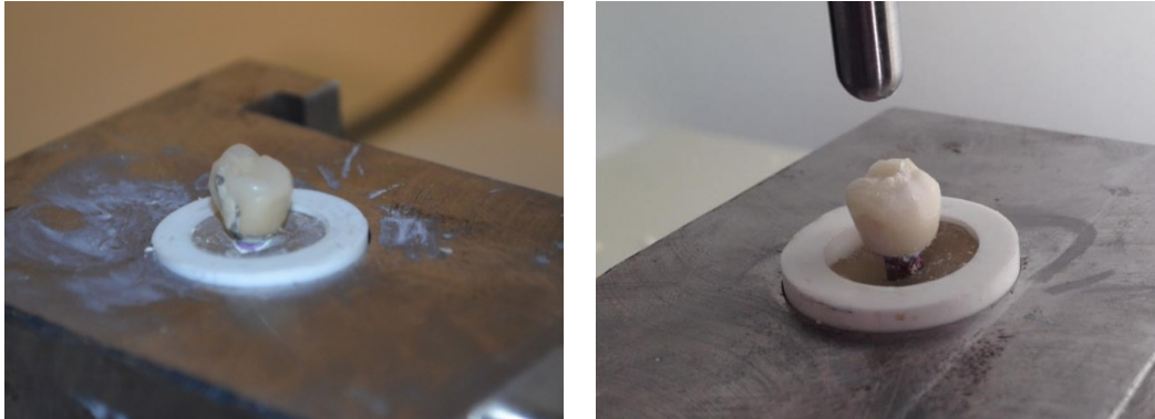
Resim 39: Tip II Kırılma. Porselen-veneer arayüzünde ortaya çıkan adeziv kırılma (delaminasyon).
