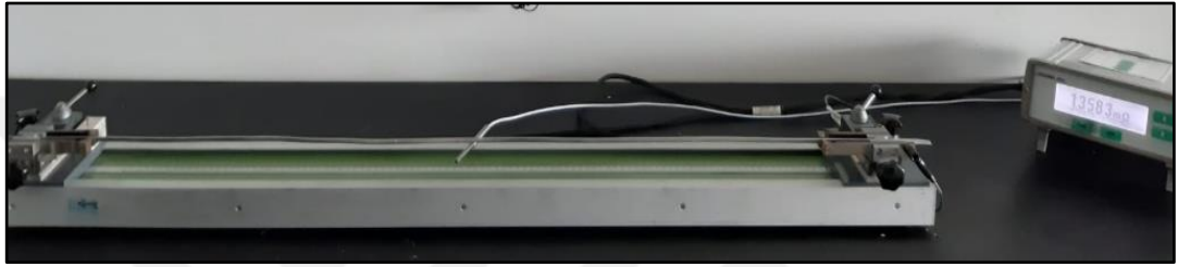
Şekil 3.42. ACCC Lisbon iletkeninde kullanılan tek telin direnci 1.3583 \text{ m}\Omega olarak ölçülmüştür
