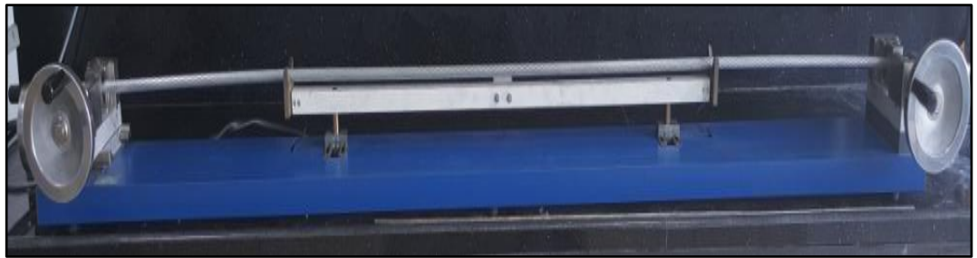
Şekil 3.43. ACCC Lisbon iletkenin direnç ölçer cihazına yerleştirilmesi
