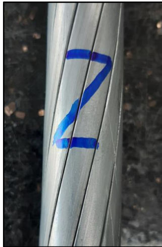
Şekil 3.27. ACCC Lisbon iletkeninin sağ adım yönünde örüldüğünün gösterilişi
