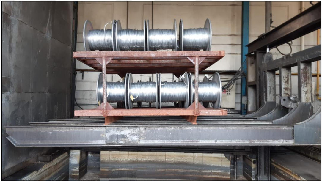
Şekil 3.21. Alüminyum tellere uygulanan ısıtıl işlem
