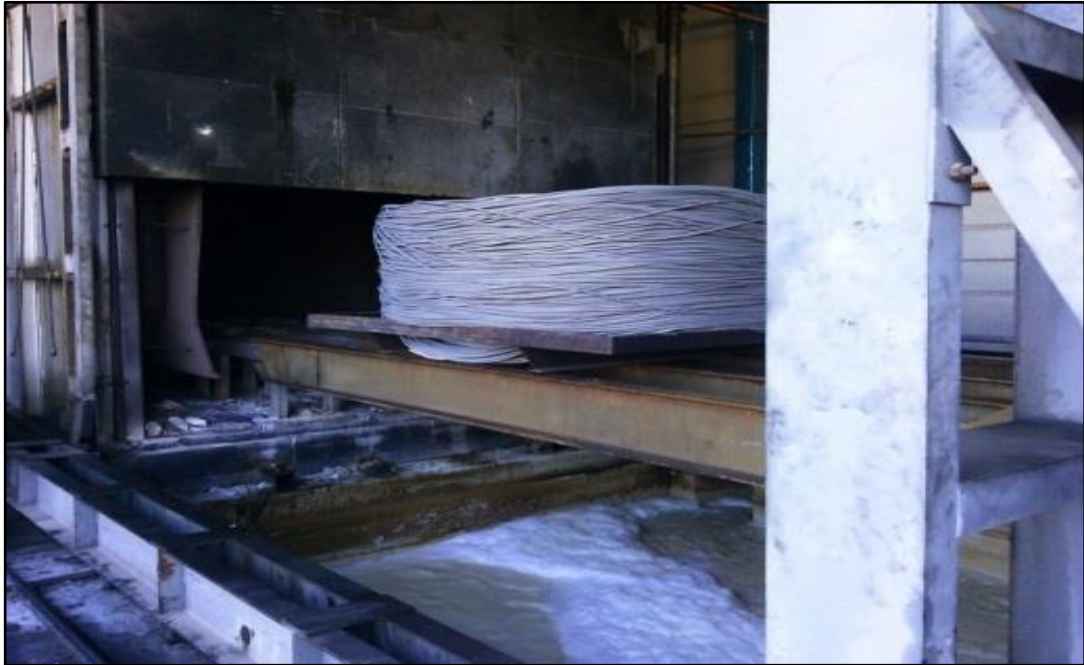
Şekil 3.20. Alüminyum filmaşine uygulanan ısıtma işlemi
