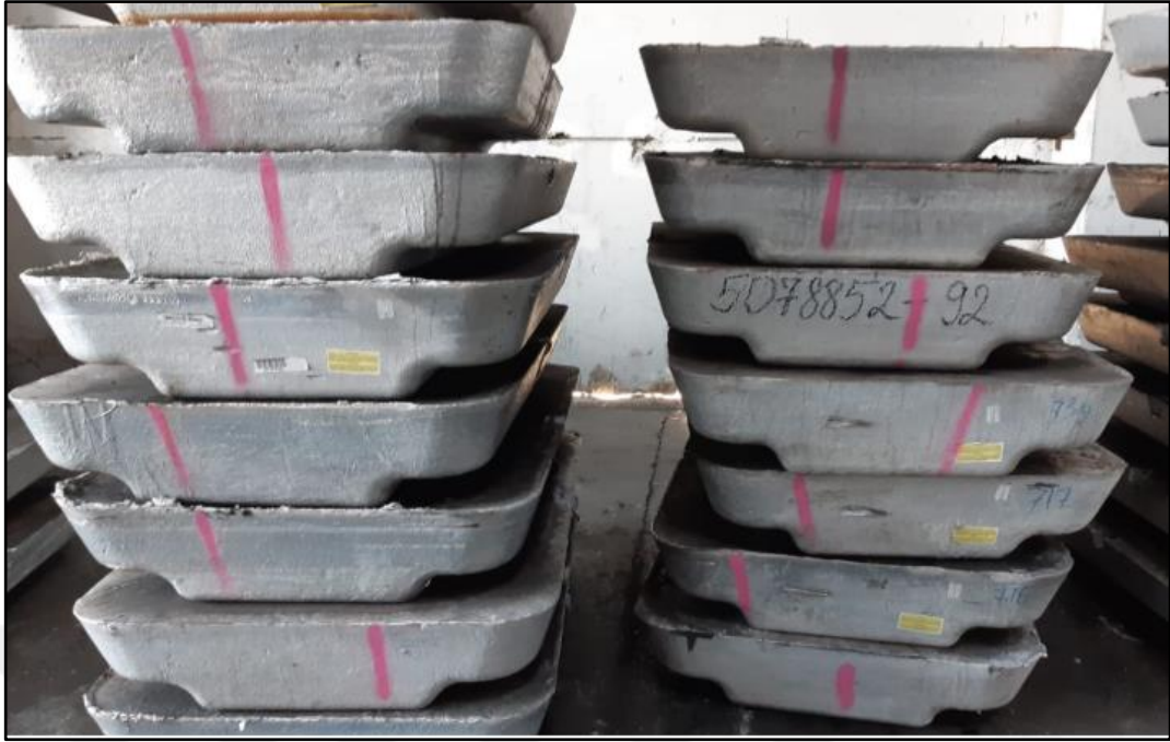
Şekil 3.6. %99.8 saflıktaki alüminyum külçe
