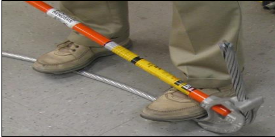
Şekil 2.19. İletken 90 derece açıyla 10 kez bükülmüştür [7].
