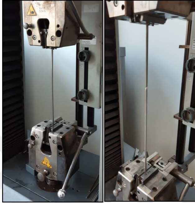
Şekil 3.49. ACCC Lisbon telinin çekme cihazıyla koparılması
