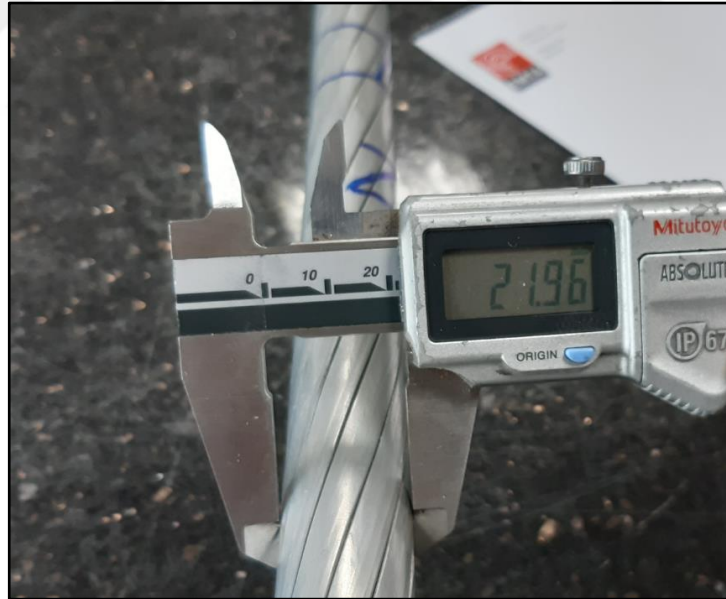
Şekil 3.30. Dış çap 21,96 mm olarak kumpas yardımıyla ölçülmüştür.
