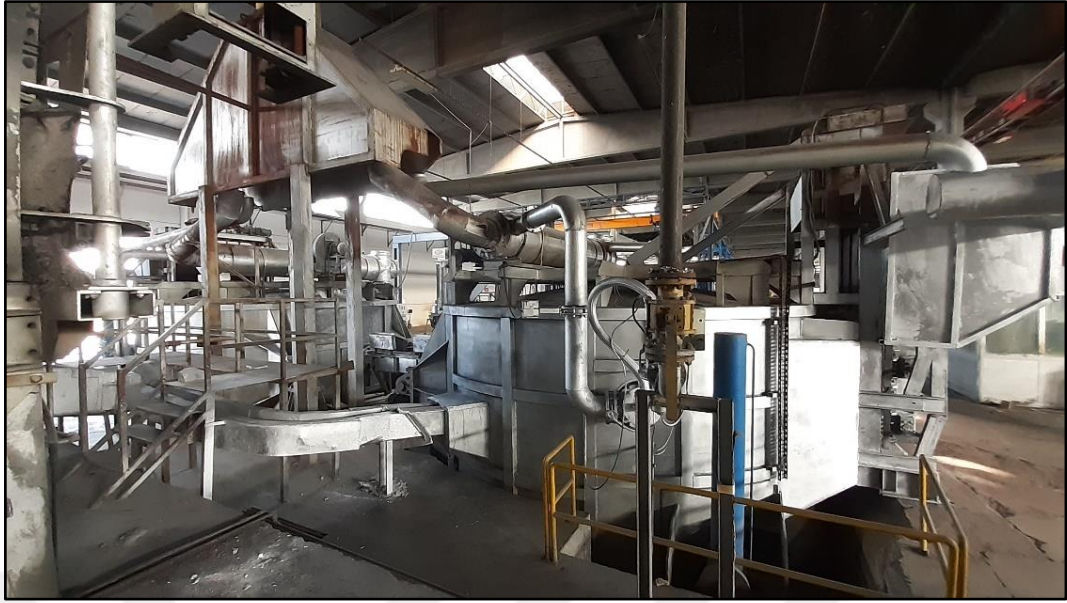
Şekil 3.8. Döküm prosesi dinlendirme fırınları
