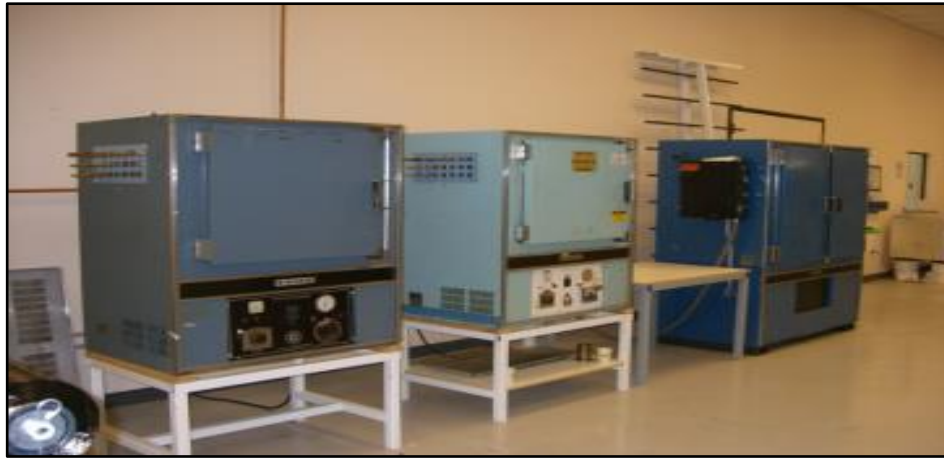
Şekil 2.21. Kompozit öz bir sene boyunca 220°C'de fırınlanmıştır [7].
