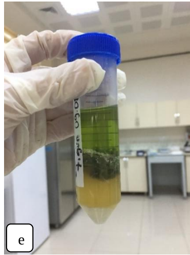
Şekil 9. Asetonitril(a) magnezyum sülfat + sodyum asetat eklenmesi(b) el ile çalkalama (c), Santrifüj işleminden önce (d), santrifüj işleminden sonra (e)
