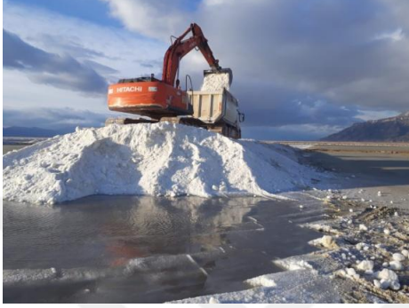
Resim 2.4 Mirabillit yığınlarının havuz içinden tesise sevki çalışmalarından bir görsel.
