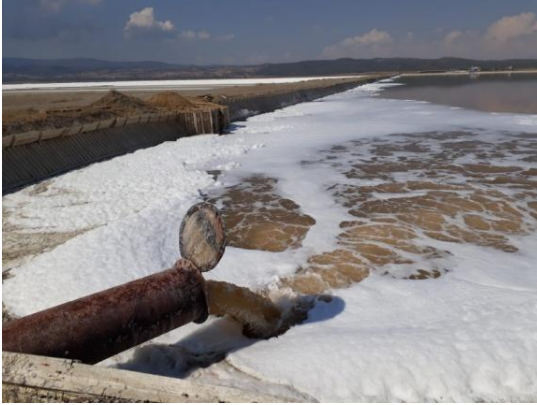
Resim 2.1 Üretim havuzuna ÖBH'dan yüksek Bome'li su alınması (a) ve soğuk hava koşullarında kristalizasyon sonrası üst tuzlu suyun boşaltılması (b).
