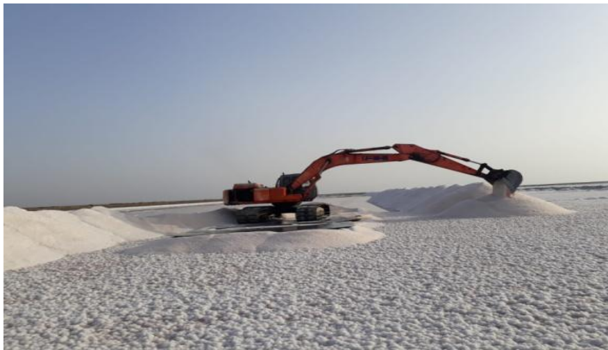
Resim 2.7 Paletli ekskavatör ile NaCl üretimi.
