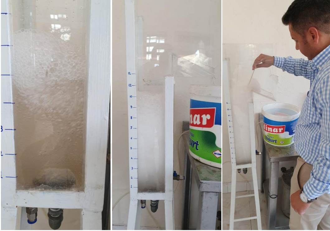
Resim 4.1 Köpürtücü ilavesiz ortamda flotasyon çalışmasından görseller.
