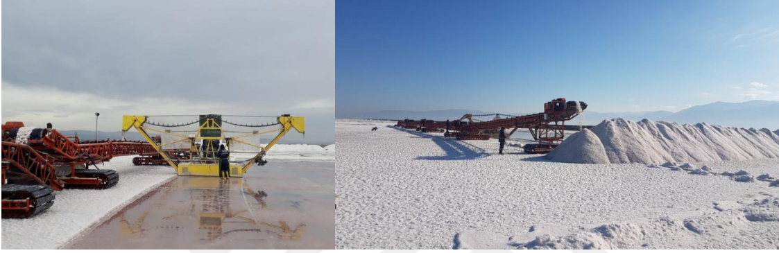
Resim 2.8 NaCl'ün havuz tabanından özel harvester'lar ile kazınarak toplanmasından görüntüler.
