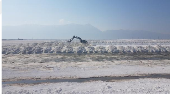
Resim 2.3 Mirabilitin iş makinaları ile toplanması.
