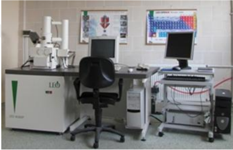
Resim 3.6 SEM analiz cihazı.
