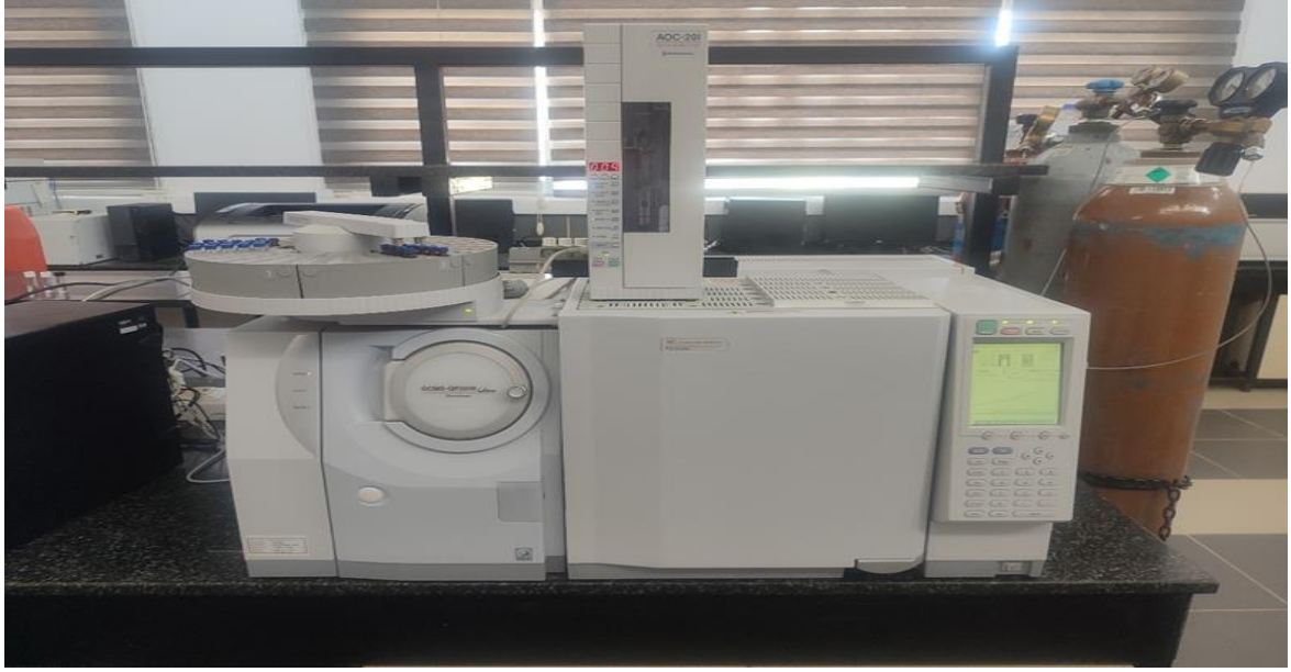
Şekil 3.3. Shimadzu GC-MS QP 2010 Ultra analiz cihazı
