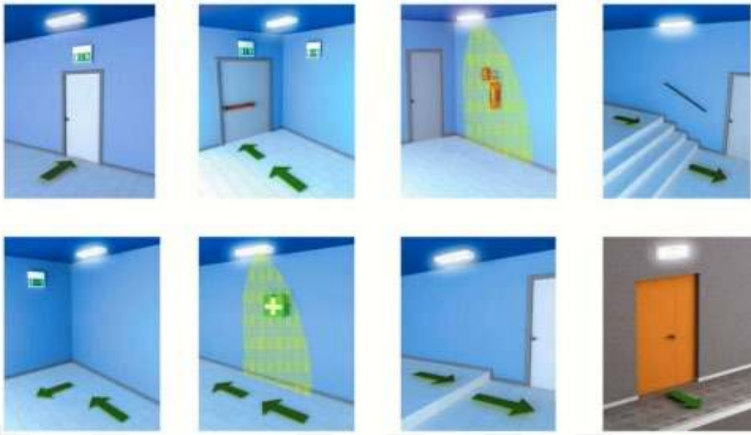
Şekil 4.4. EN 1838 standardına göre kaçış yolu aydınlatması.
