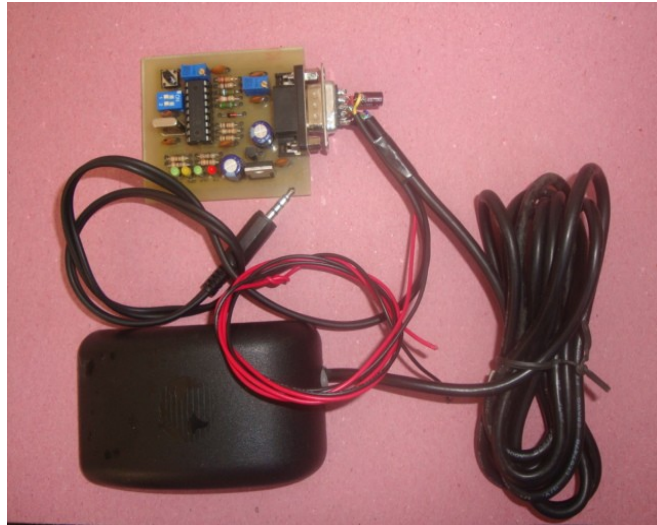
Şekil 4.13 GPS' in Tiny Tracker devresine bağlantısı
