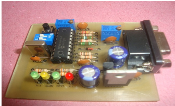
Şekil 4.11 TCM 3105 kullanılan devre (Mobil APRS ve Tinytrak)
