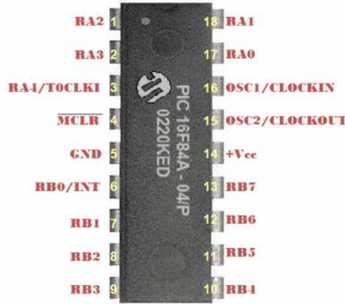
Şekil 4.6 16F84A çıkış uçları (PIC 16F48A.)
