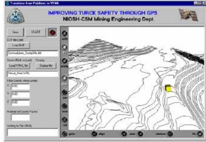
Şekil 3.10 İşletmeden elde edilen verilerle bilgisayarda oluşturulan 3 boyutlu işletme haritası (Yegulalp, T. M. 1983)
