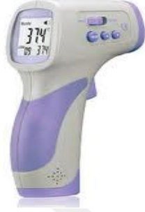
Resim 1: Cilt sıcaklığını ölçen termometre (araştırmacının arşivinden)
