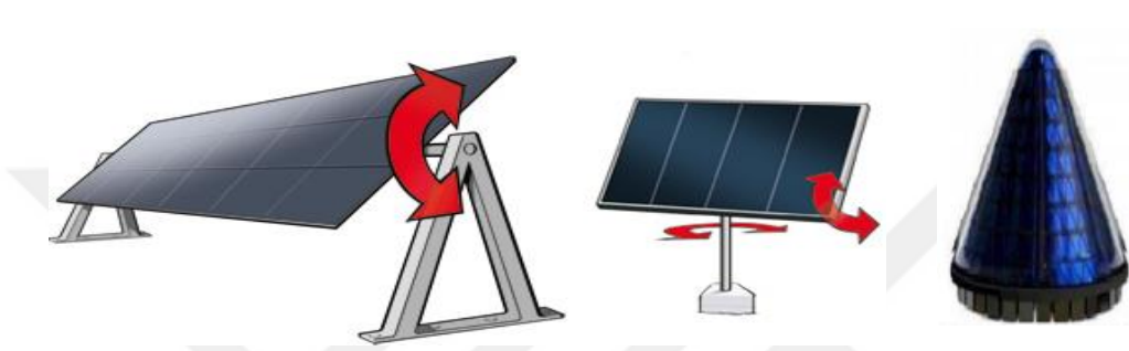
Şekil 2.11 Eksenlerine Göre Güneş Takip Sistemleri
