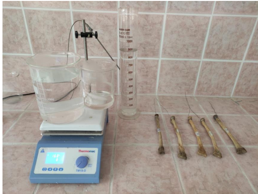
Şekil 3.6: Arşimet Prensibi ile radius kemiklerinin hacminin hesaplanması.
