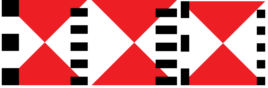
Şekil 4.7 YKN'lerin havadan görülmesi için kullanılan plakalar
