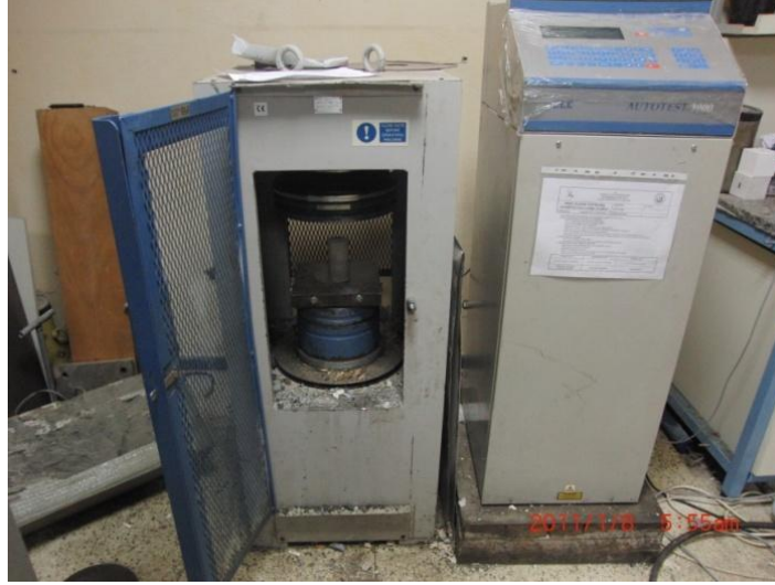
Şekil 5.2 300 ton kapasiteli pres.
