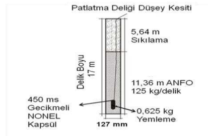
Şekil 4.70 Deney 1 patlatma deliği düşey kesiti (ölçeksiz).
