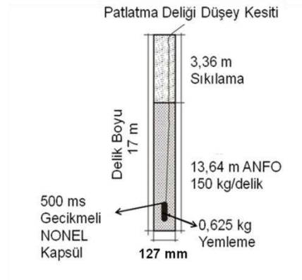
Şekil 4.117 Deney 9 patlatma deliği düşey kesiti planı (ölçeksiz).
