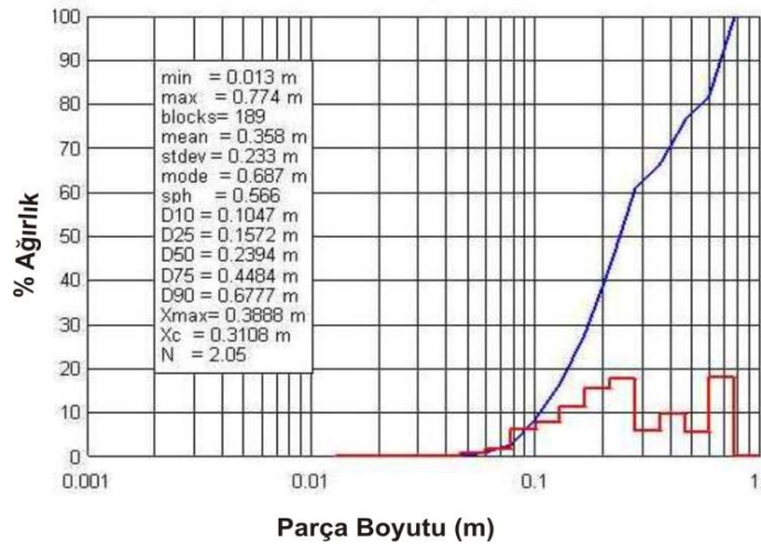
Şekil 4.166 Örnek olarak Deney 8'e ait patlatma yığınının bir fotoğrafın görüntü analiz aşamaları.
