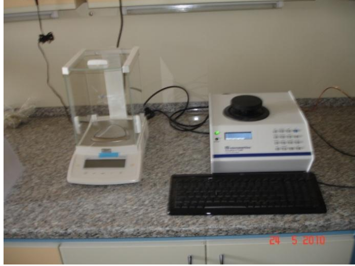
Şekil 5.1 Yoğunluk testlerinde kullanılan helyum piknometre.
