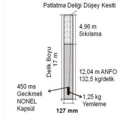
Şekil 4.81 Deney 3 patlatma deliği düşey kesiti planı (ölçeksiz).
