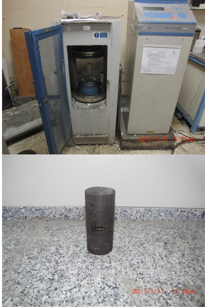
Şekil 5.4 Tek eksenli deformasyon deneyi için kullanılan pres ve numunenin hazırlanışı.
