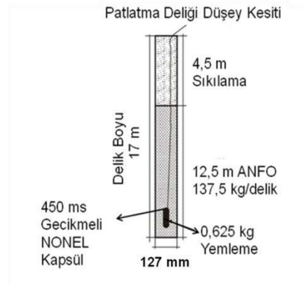
Şekil 4.93 Deney 5 patlatma deliği düşey kesiti planı (ölçeksiz).
