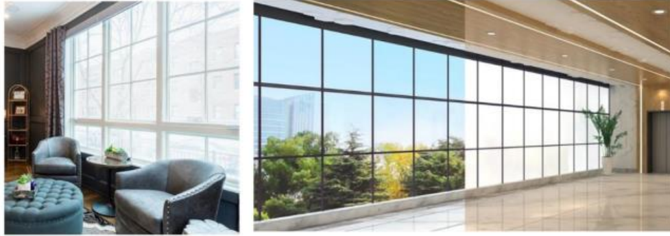
Şekil 7. Termo-Kromik Camın Farklı Durumda Görünümleri
