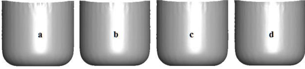
Şekil 6.3. 100°C ve 1200 N BPK'ne ait numuneler a) \alpha=0^\circ b) \alpha=5^\circ c) \alpha=10^\circ d) \alpha=15^\circ
