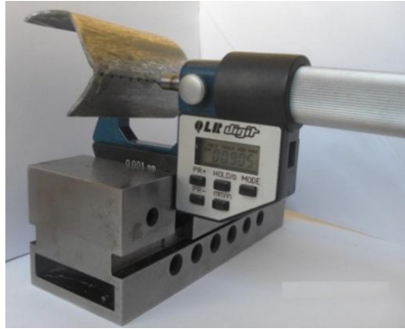
Şekil 5.50. Et kalınlıklarının ölçülmesi
