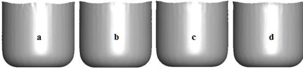
Şekil 6.2. 25 °C ve 1200 N BPK'ne ait numuneler a) \alpha=0^\circ b) \alpha=5^\circ c) \alpha=10^\circ d) \alpha=15^\circ
