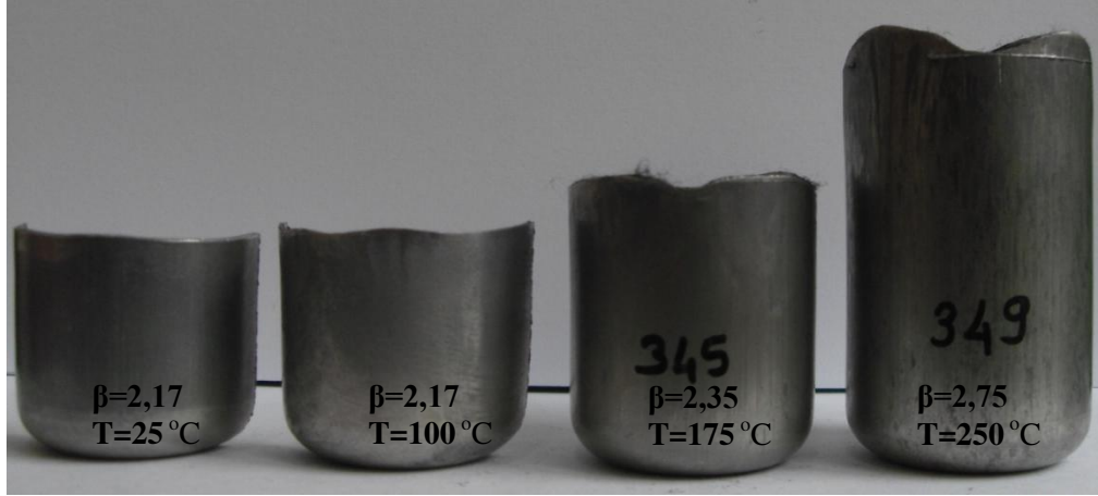
Şekil 5.46. 3600 N BPK ve \alpha=15^\circ deneylerinden elde edilen numuneler
