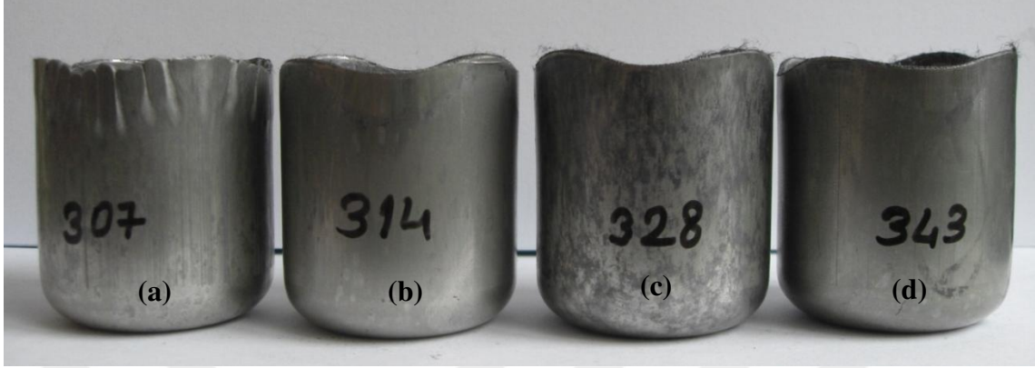
Şekil 5.12. 175 °C ve 1200 N BPK sonucunda elde edilen numuneler a) \alpha=0^\circ b) \alpha=5^\circ c) \alpha=10^\circ d) \alpha=15^\circ
