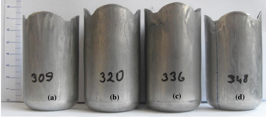
Şekil 5.20. 250 °C ve 2400 N BPK sonucunda elde edilen numuneler a) \alpha=0^\circ b) \alpha=5^\circ c) \alpha=10^\circ d) \alpha=15^\circ
