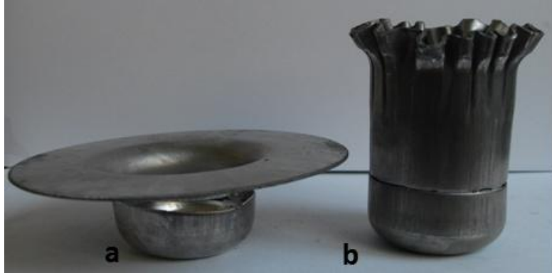
Şekil 5.70. Çekilen kaplarda oluşan yırtılma(a) ve buruşma(b) hataları
