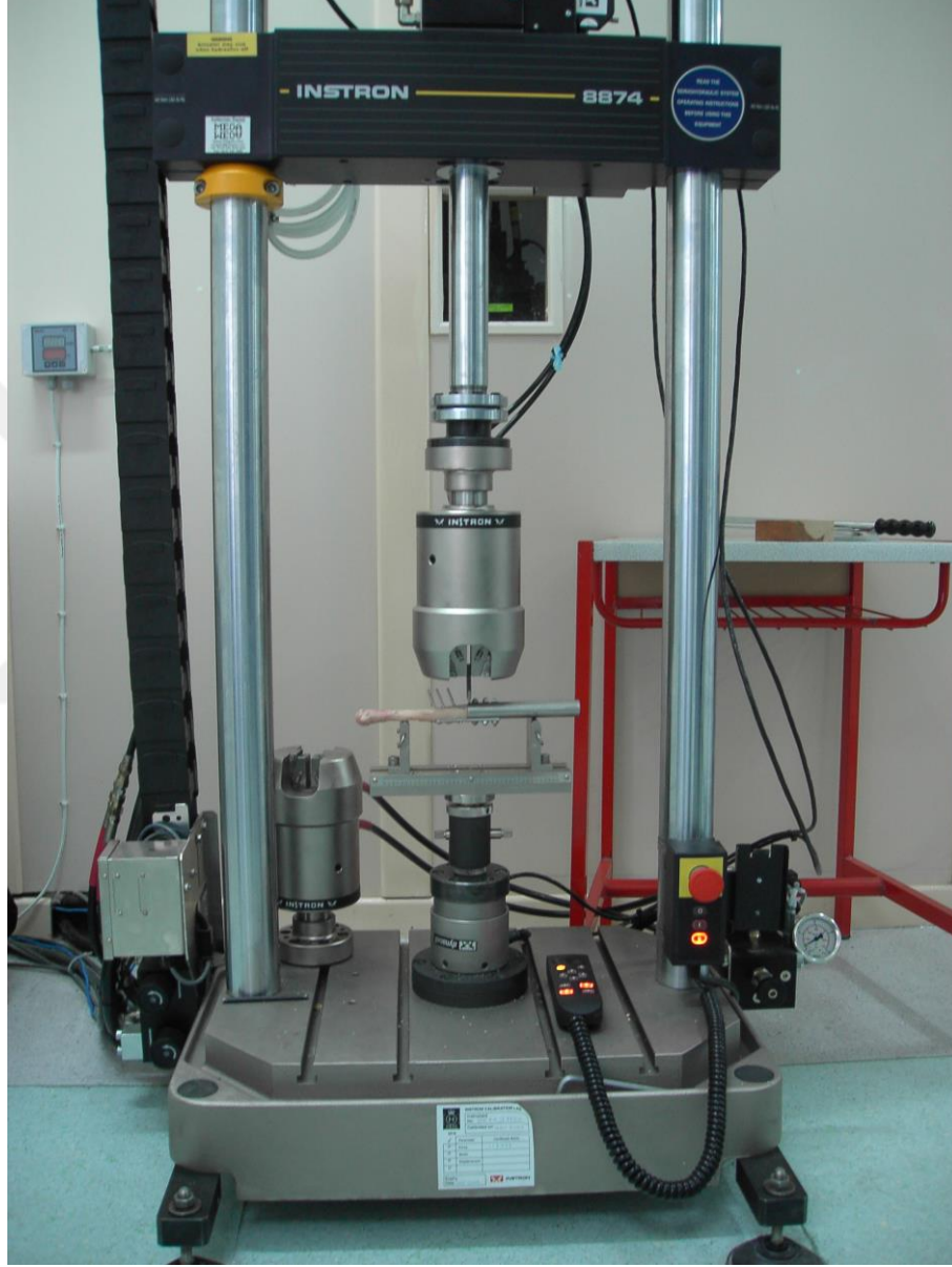
Şekil 3.9. Eğilme testleri genel sistem görüntüsü
