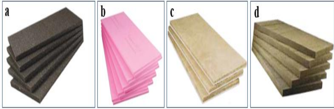
Şekil 4.25. Yapıda kullanılan yalıtım malzemeleri; a) ekstrüde polistiren (XPS); b) ekspande polistiren (EPS); c) camyünü; d) taşyünü (İzocam 2021)
