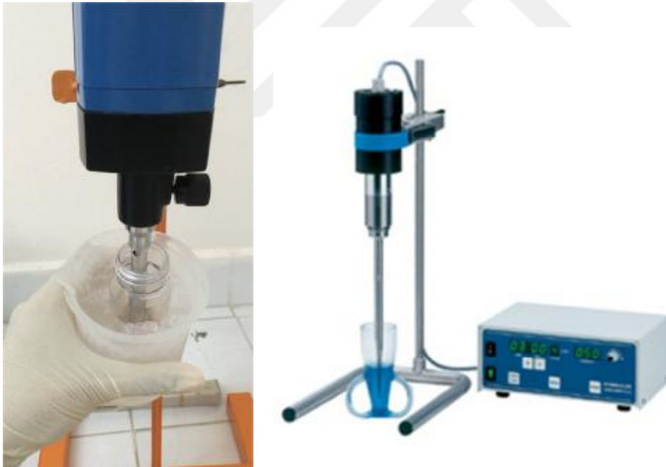
Şekil 4.5. Ultra Turrax ve Sonikatör İle Parçalama İşlemi
