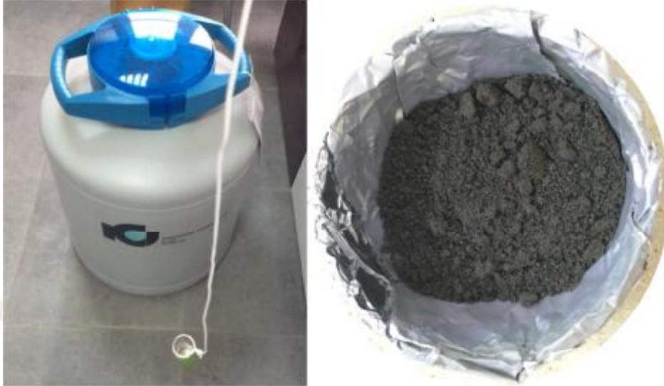
Şekil 4.4. Sıvı Azot Tankı ve Sıvı Azot İle Parçalanmış Toz Haldeki Küf Örneği
