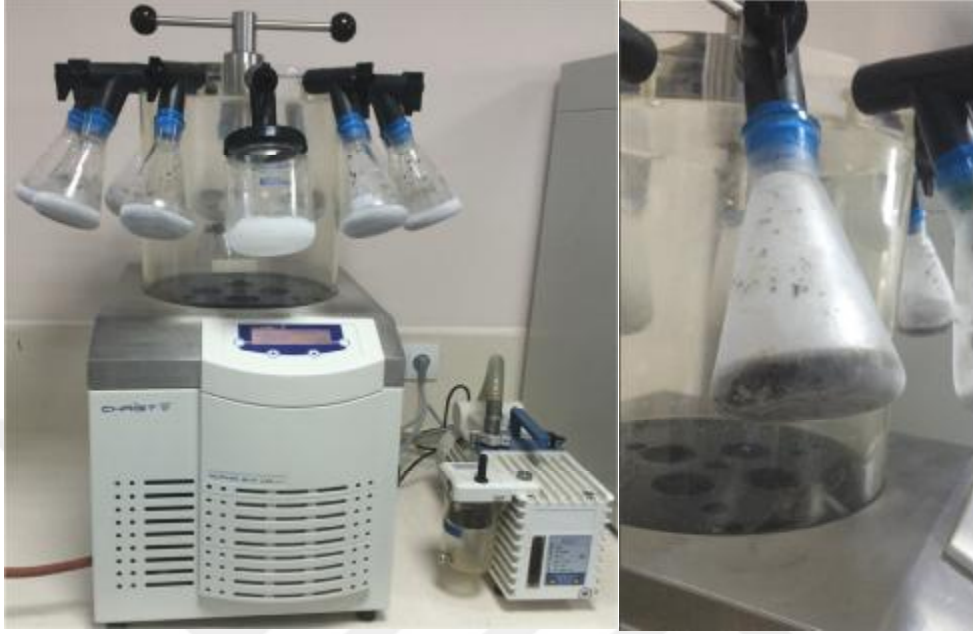
Şekil 4.6. Liyofilizasyon Uygulaması (0,0010 mbar Basınç Altında, -82°C’de, 24 Saat)
