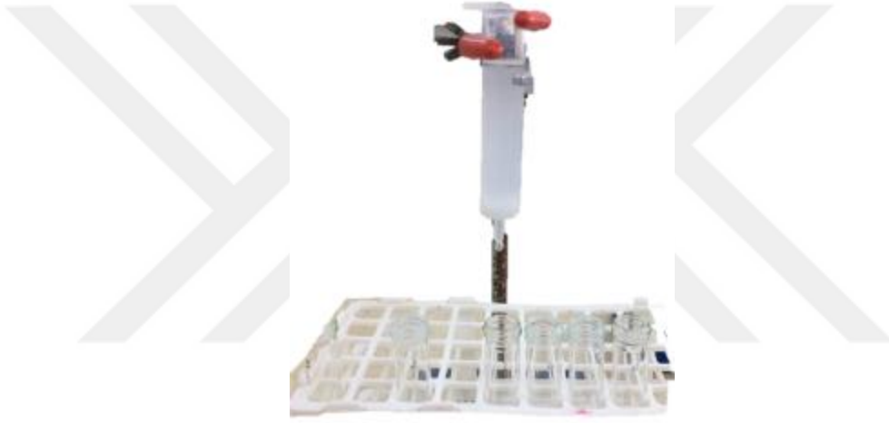
Şekil 4.11. Sephadex G-100 Kolon Kromatografisi
