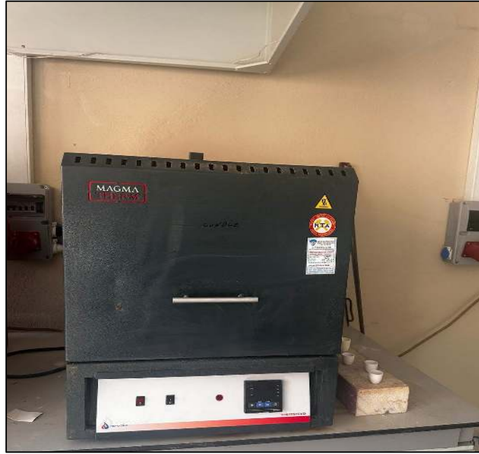
Şekil 3.19: Kalsinasyon çalışmalarında kullanılan kül fırını.
