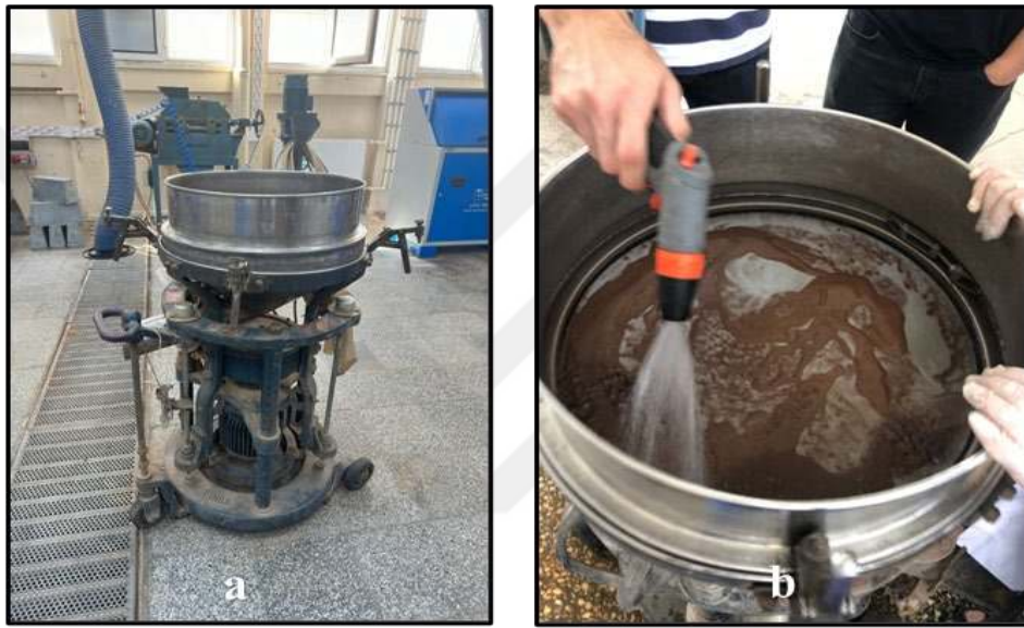
Şekil 3.13: Boyuta göre ayırmada kullanılan Russel elek görselleri.
