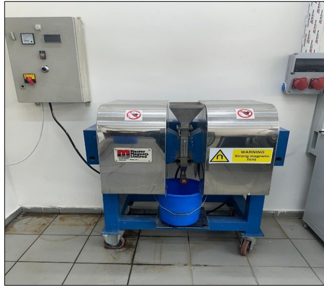
Şekil 3.15: Laboratuvar tipi yüksek alan şiddetli yaş manyetik ayırıcı.
