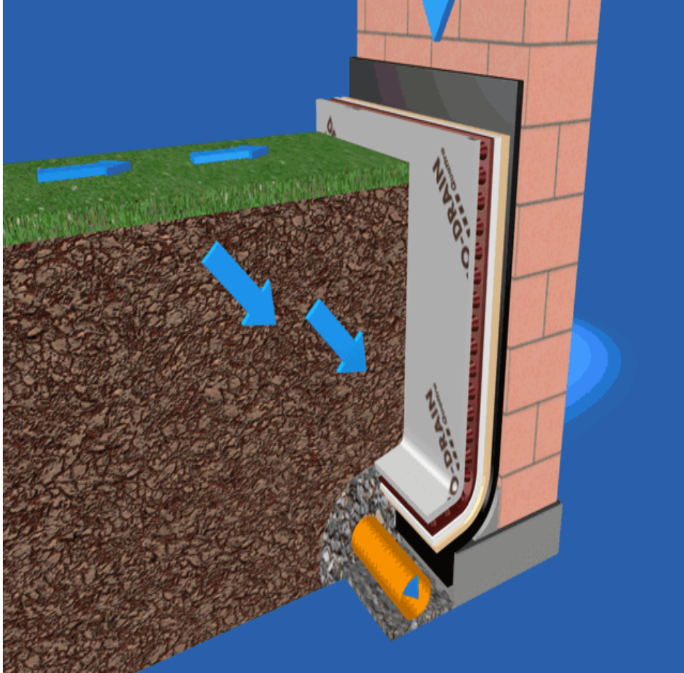
Şekil 4.6. Temel Yapılmış Olan Su ve Isı Yalıtımı
