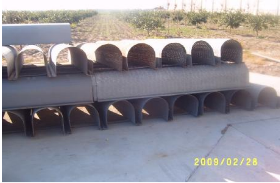
Şekil 3.11. 2. ve 3. Deponun Havalandırma Kanalları (Delikli Kanallar)
