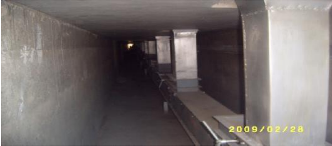
Şekil 3.6. Ek-(20)'de Planlanan Deponun, Hububatı Depodan Araçlara Boşaltma Sistemi
