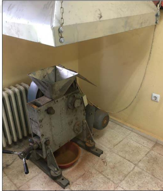
Şekil 3.12. Numunelerin kırıcıda öğütülmesi
