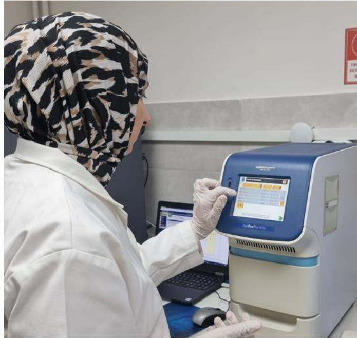
Şekil 3.6-A. IBV tespiti sırasında laboratuvarında kullanılan StepOnePlus™ Gerçek Zamanlı PCR Sistemi'nin (Applied Biosystems, ABD) çalışması.
