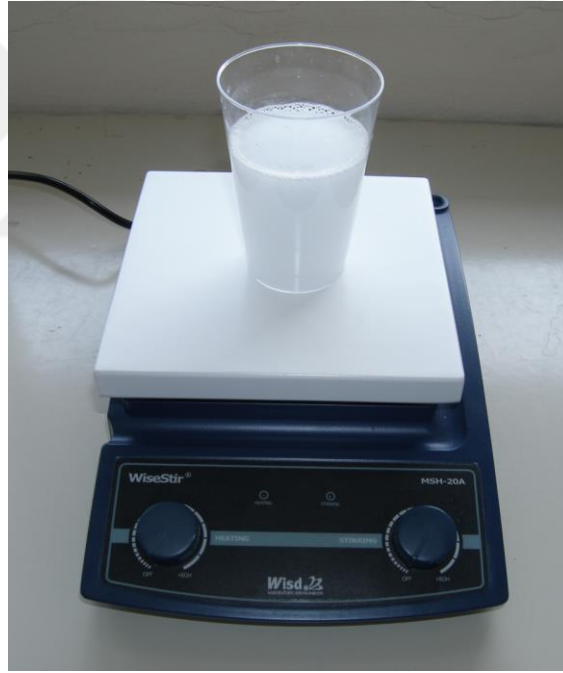
Şekil 3.2. Akarisit konsantrasyonlarının manyetik karıştırıcıda hazırlanması
