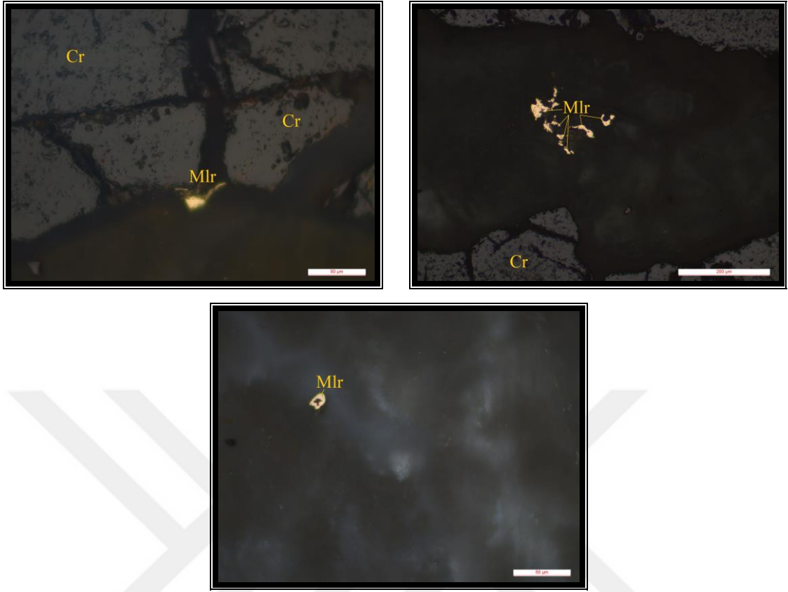
Şekil 4.43. Cevher mikroskobunda gang minerallerinin aralarında kırıklı çatlaklı kromit tanelerinin ve millerit minerallerinin görünümü (Cr: kromit, Mlr: millerit).
