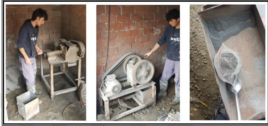
Şekil 3.1. Numunelerin kırılıp öğütülerek pudra haline getirilmesi.
