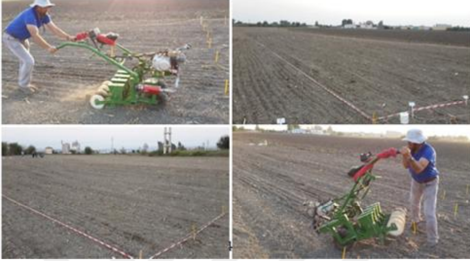
Şekil 3.8. Denemenin kurulması ve küçük alanlar için kullanılan ekim makinası
