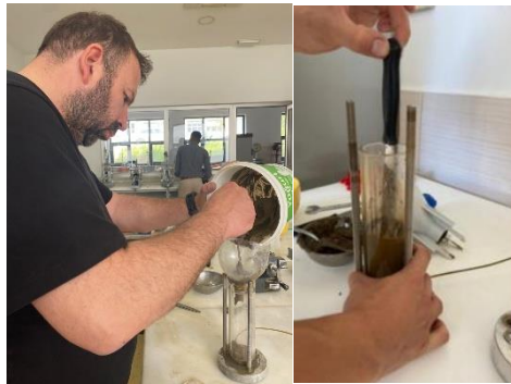
Şekil 5.2. Numunenin hücre içerisine konulması
