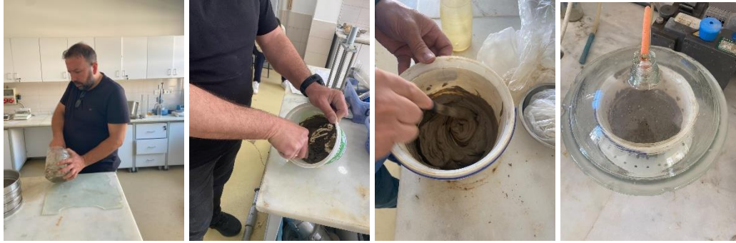
Şekil 5.1. Bulamaç yöntemiyle numune hazırlanması ve desikatörde hava boşluklarının alınması
