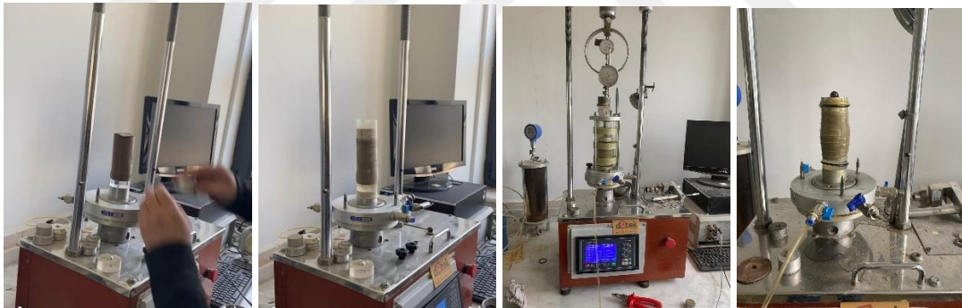
Şekil 5.4. Numunenin üç eksenli deney düzeneğine konması ve deney sonrası deformasyonu
