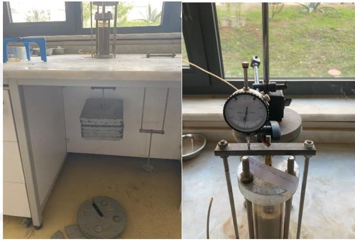
Şekil 5.3. Ön konsolidasyona tabi tutulan numunenin mikroölçerle eksenel boy kısalması takibi
