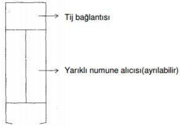
Şekil 2.11. SPT, örselenmiş numune alıcı [43].
