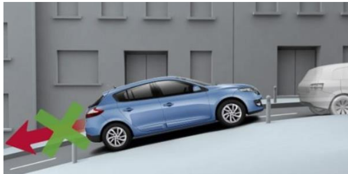
Şekil 3.10 Yokuş Kalkış Destek Sistemi [95]
