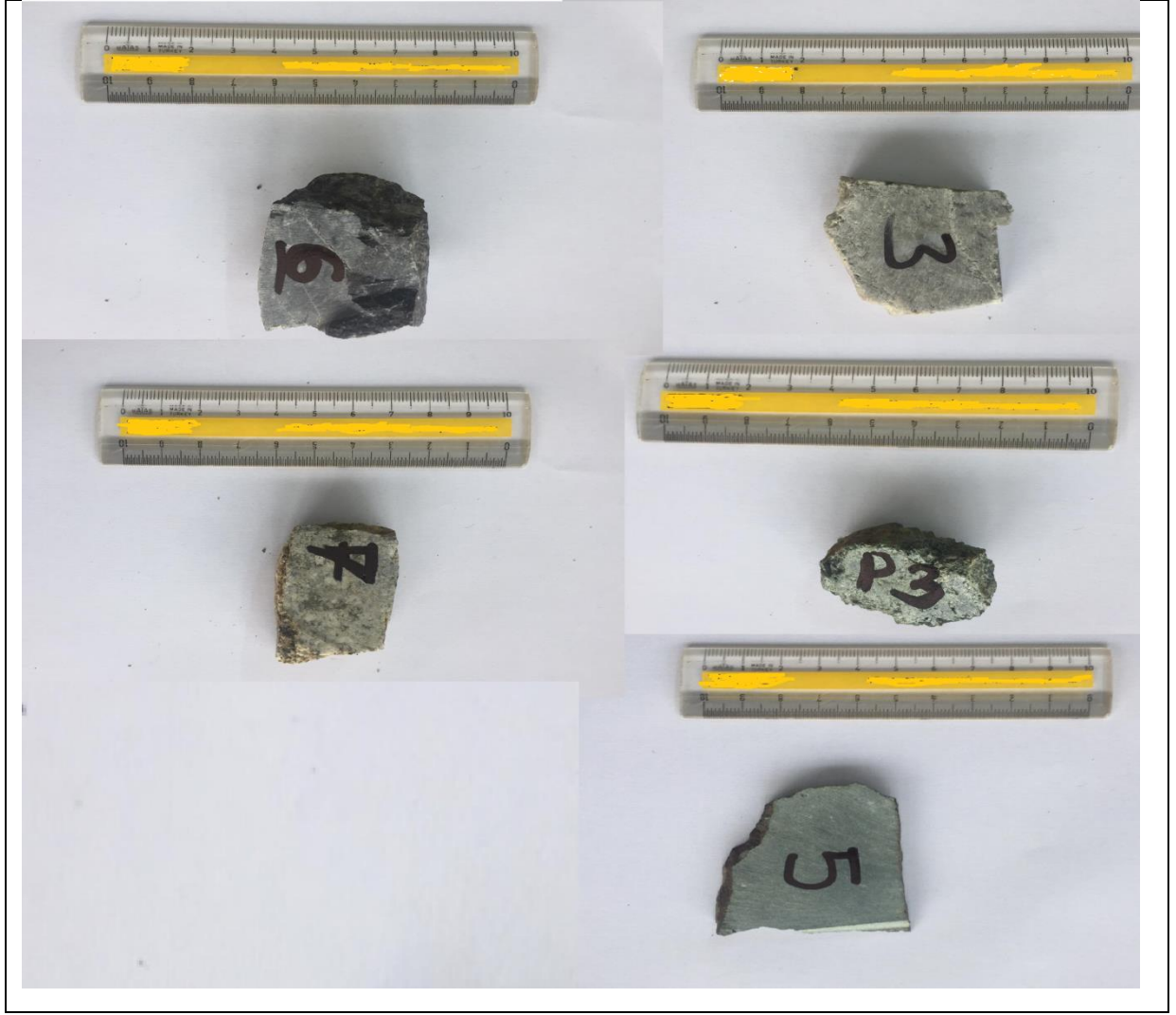
Şekil 4.4 Sahadan alınan numunelerden parlatma blok kesit için hazırlananlar (Z.B.E.Ü. Jeoloji Mühendisliği Bölümü Jeokimya Laboratuvarı).
