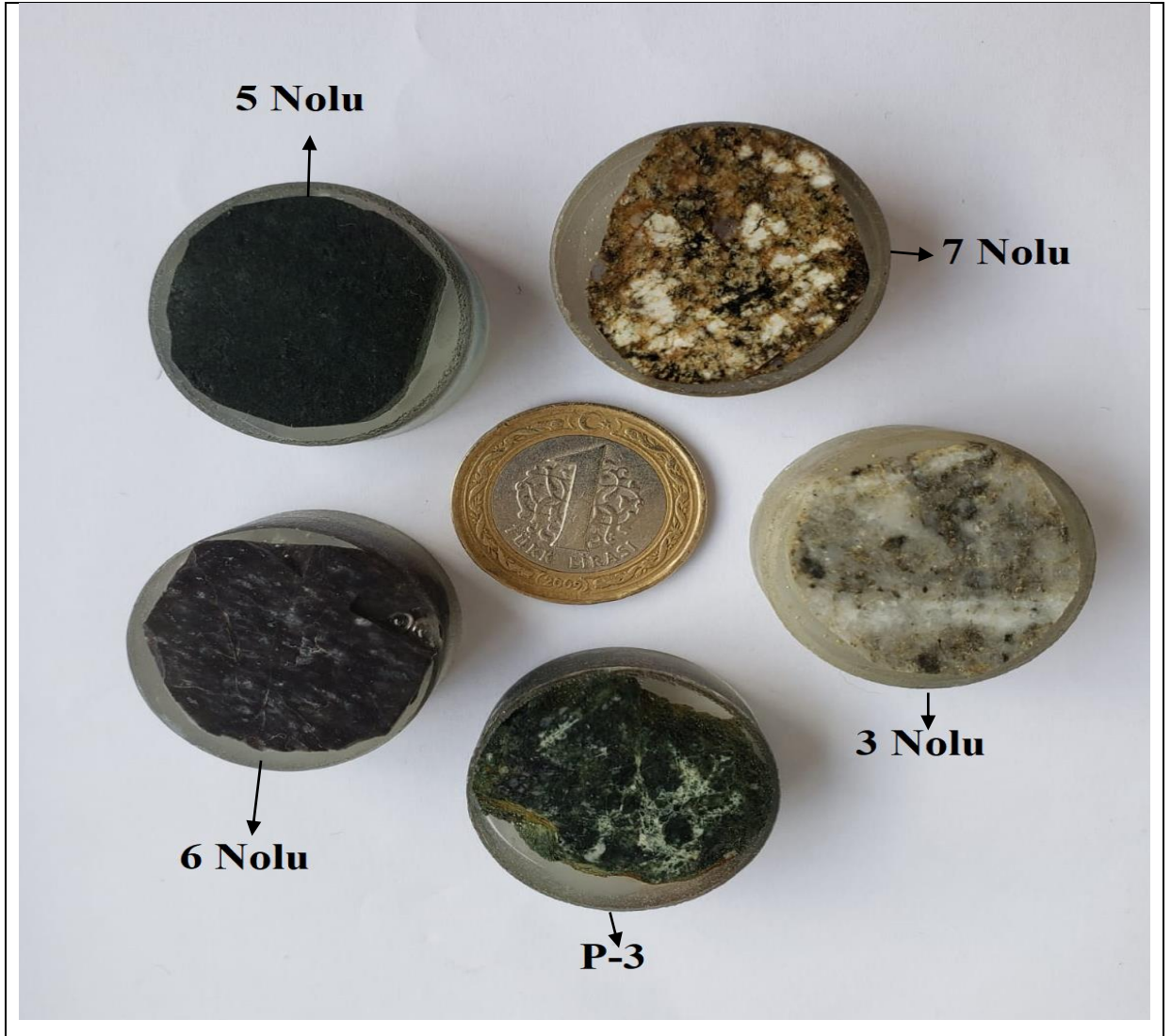
Şekil 4.5 Cevher mikraskobunda optik incelemeler için hazırlanan parlatma blok kesitleri (Z.B.E.Ü. Jeoloji Mühendisliği Bölümü Parlatma Laboratuvarı).
