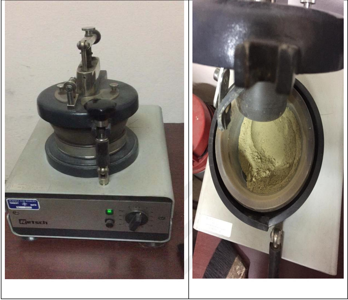
Şekil 4.3 Sahadan alınan numunelerin kimyasal analiz için agat değirmende öğütülmesi (Z.B.E.Ü. Jeoloji Mühendisliği Bölümü Jeokimya Laboratuvarı).
