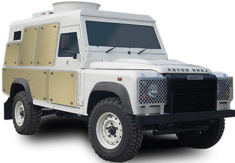
Şekil 1.2. Aplike zırh sisteminin araç üzerindeki görünümü
