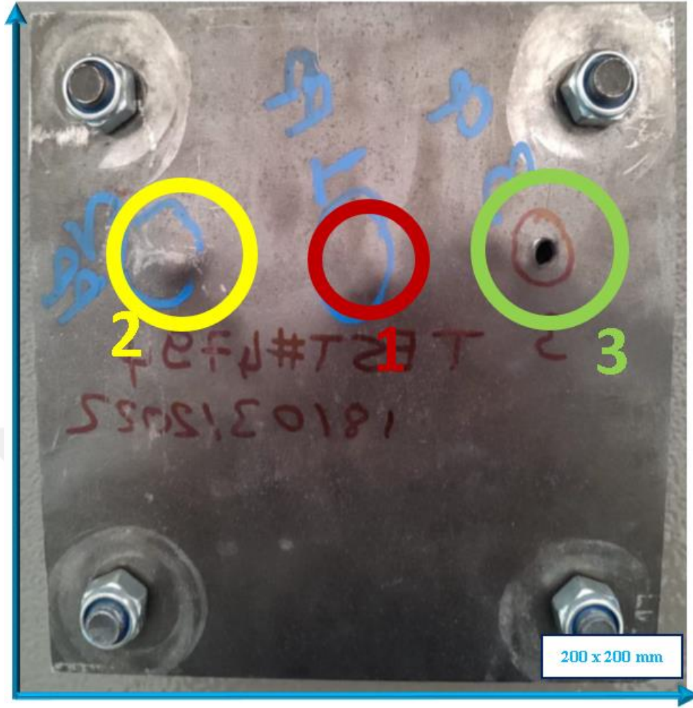
Şekil 8.10. Birinci zırh konfigürasyonu arkadan atış sonrası görünümü
