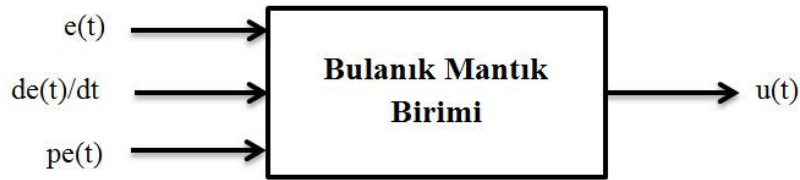
Şekil 3.26. Sistemde kullanılan bulanık mantık kontrolörün blok diyagramı
