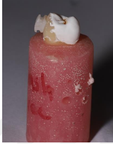
Şekil 5. 1. Mide asidinde 24 saat bekleyen örnek
