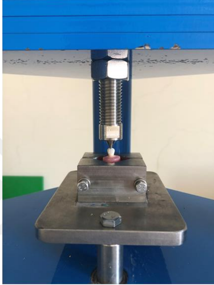
Şekil 3. 14. Universal test cihazında (Esetron, ESEMIN5TD20116, MOD Dental, Ankara, Türkiye) braketlere sıyrma testi uygulanması
