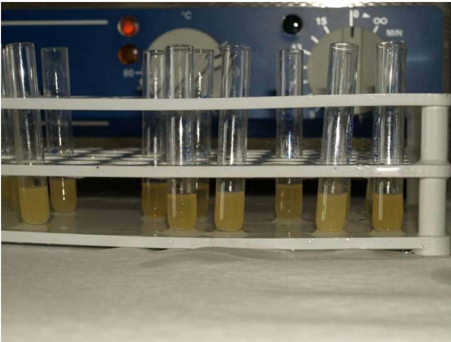
Şekil 32: Çalkalama ve santrifüj işlemlerinden sonra organik fazları alınacak karışımlar
