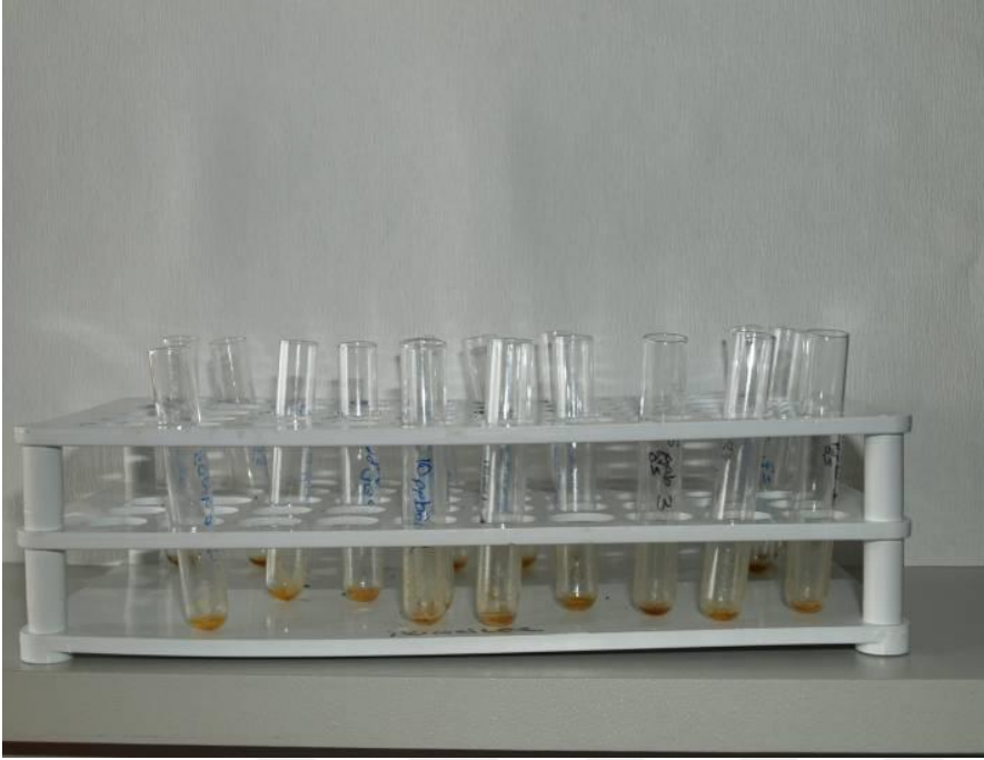
Şekil 33: Azot gazı altında uçurulmuş karışımlar
