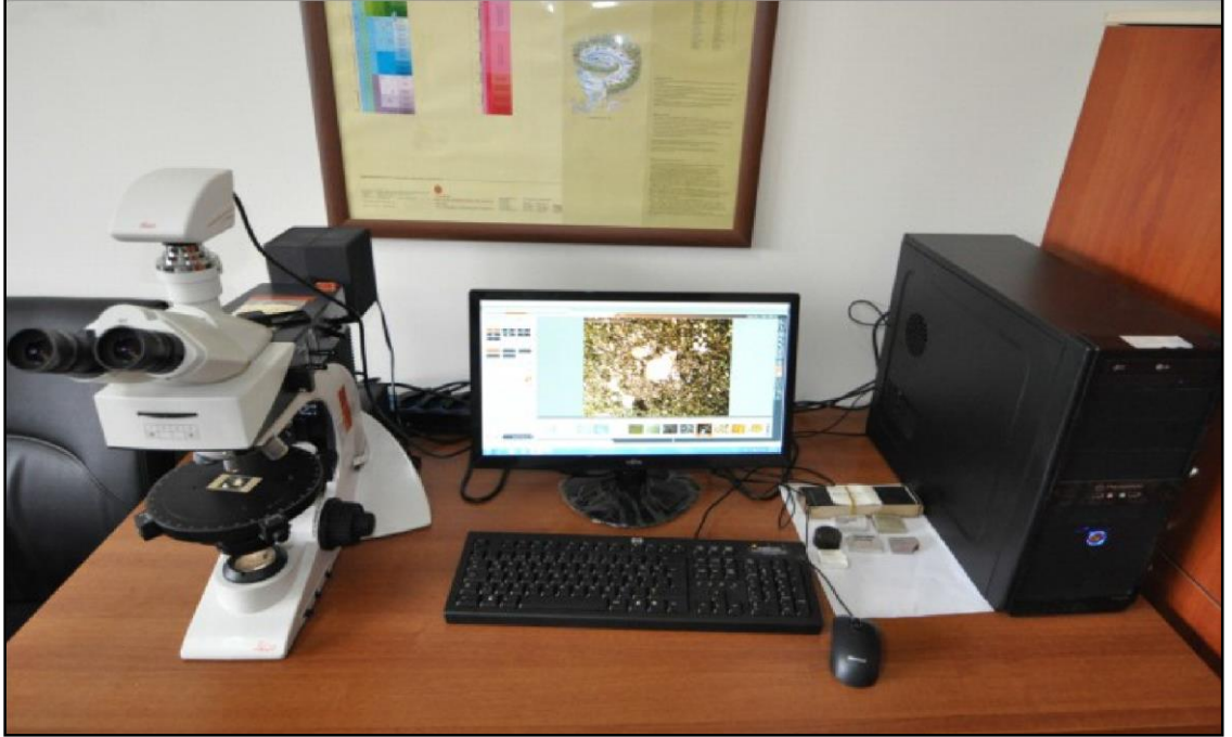
Şekil 2.2. Batman Üniversitesi Jeoloji Mühendisliği Bölümü Altan ve üstten aydınlatmalı Araştırma Mikroskobu
