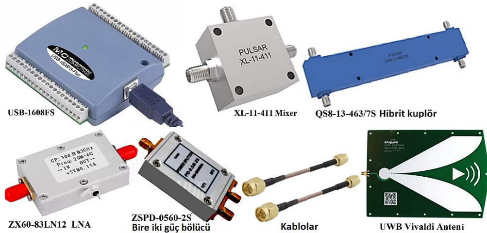
Şekil 3.10. SFCW-GPR sisteminde kullanılan bazı donanım bileşenleri.
