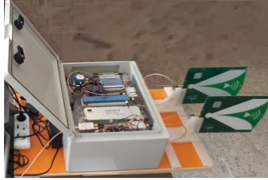
Şekil 3.8. SFCW-GPR sistem kutusu ve anten sabitleme mekanizmasının üstten görünümü.
