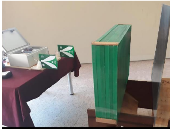
Şekil 3.13. 18,5 cm PE katmanı, 30 cm hava katmanı ve metal yansıtıcıdan oluşan yapı.
