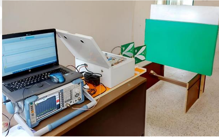
Şekil 3.7. SFCW-GPR sisteminin ölçüm düzeneği.
