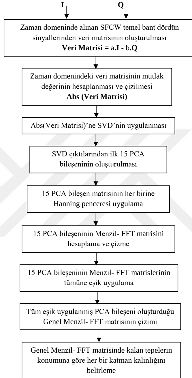
Şekil 3.18. LTE için önerilen PCA tabanlı sinyal işleme yönteminin adımları.
