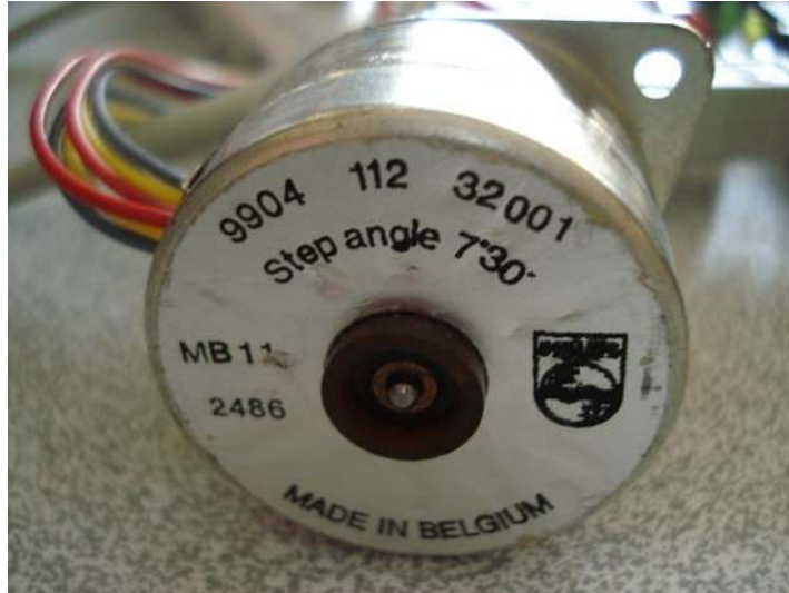
Şekil 5.7. Devrede kullanılan adım motoru
