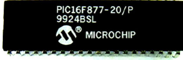
Şekil 4.6. PIC16F877 mikrodeneleyicinin üstten görünüşü
