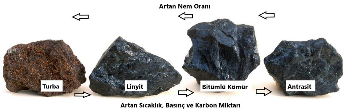
Şekil 2.3 Sıcaklık ve basınç altında kömürleşme süreci
