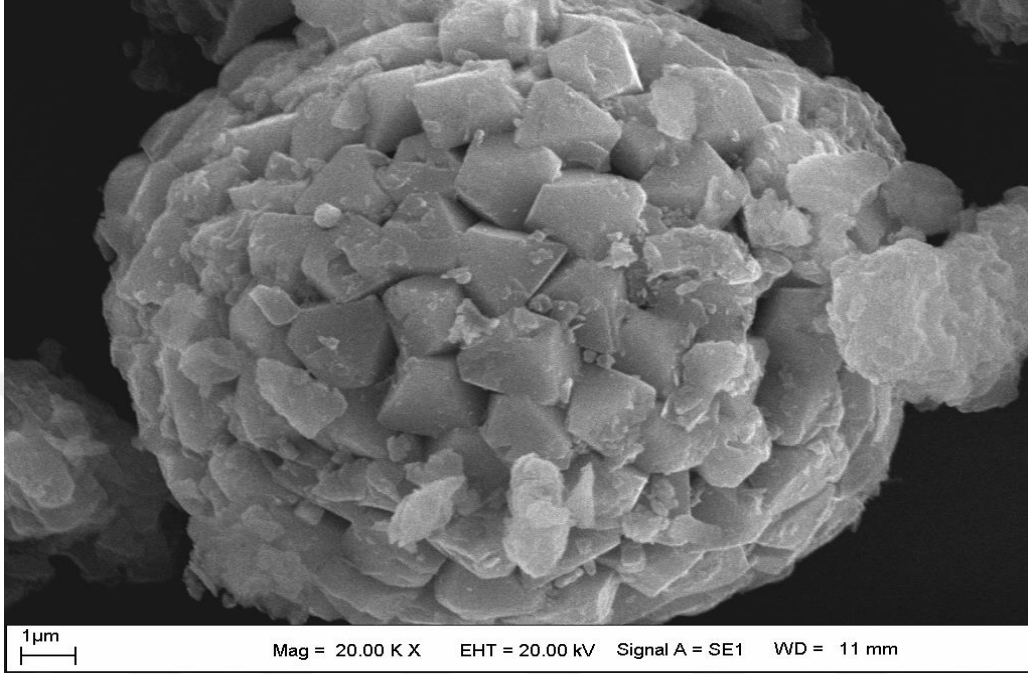
Şekil A.1 Adsorpsiyon işlemi öncesi turbanın SEM görüntüsü
