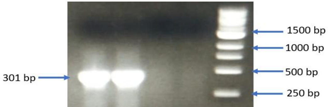
Şekil 4.5 Filogrup D veya E olma olasılığı olan örneklerin spesifik olarak sadece grup E'yi amplifiye eden primerler kullanılarak yapılan PCR sonrası jel görüntüsü (250 bp'lik DNA markırı kullanılmıştır).
