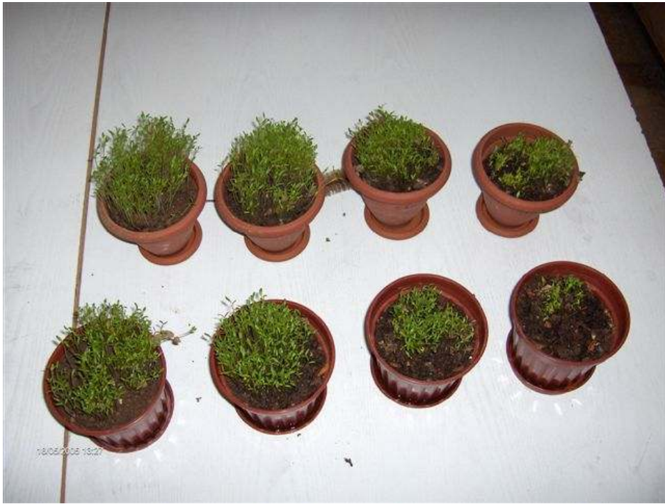
Şekil Ek 3.2 A-1 ve A-2 reaktörleri nihai ürünleri fitotoksisite testi sonuçları 2
