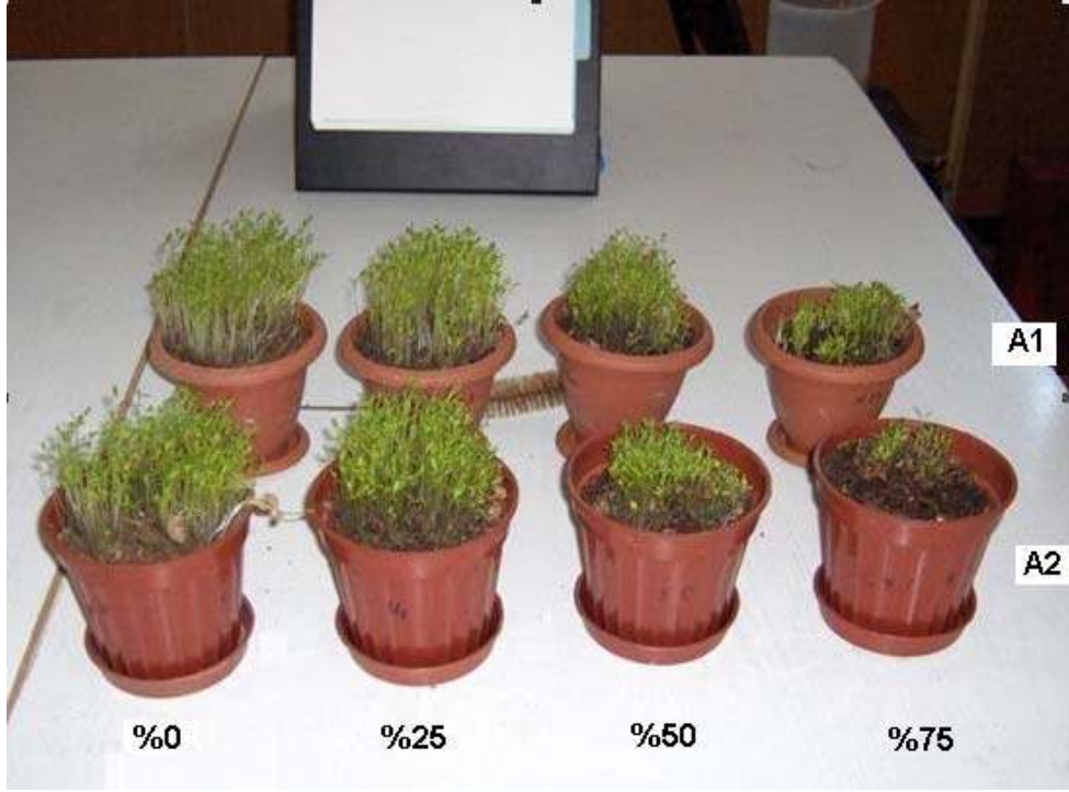
Şekil Ek 3.1 A-1 ve A-2 reaktörleri nihai ürünleri fitotoksisite testi sonuçları 1
