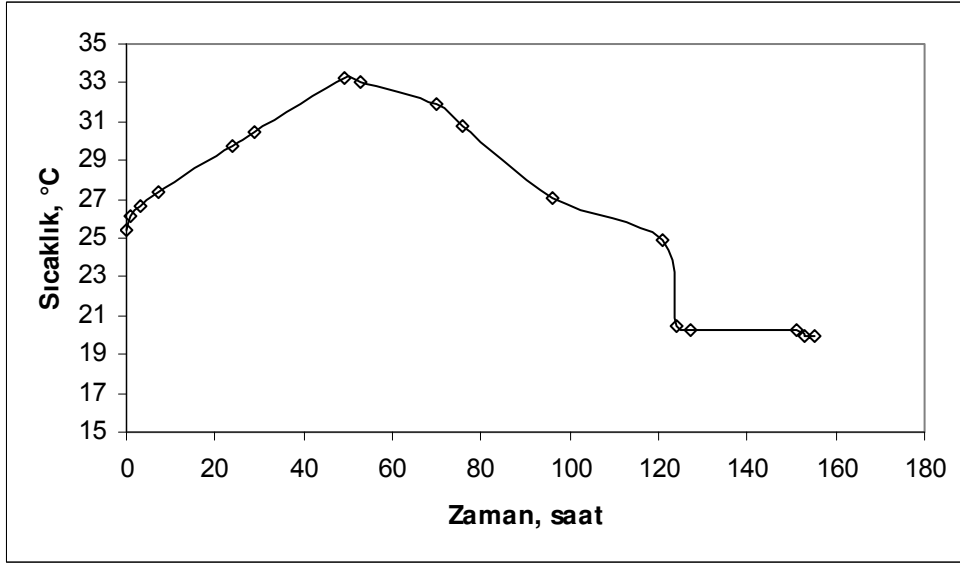
Şekil 6.1 Kompost numunesi 1 Dewar testi sonuçları
