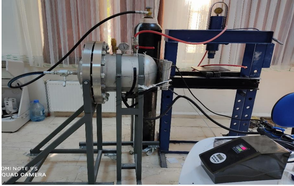
Şekil 3.23. Süper kritik kurutma için deney seti görüntüsü
