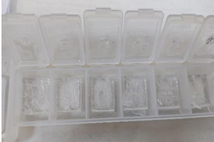
Şekil 3.26. Kurutma işlemi tamamlanmış dikdörtgen şekilli TMOS aerojelleri
