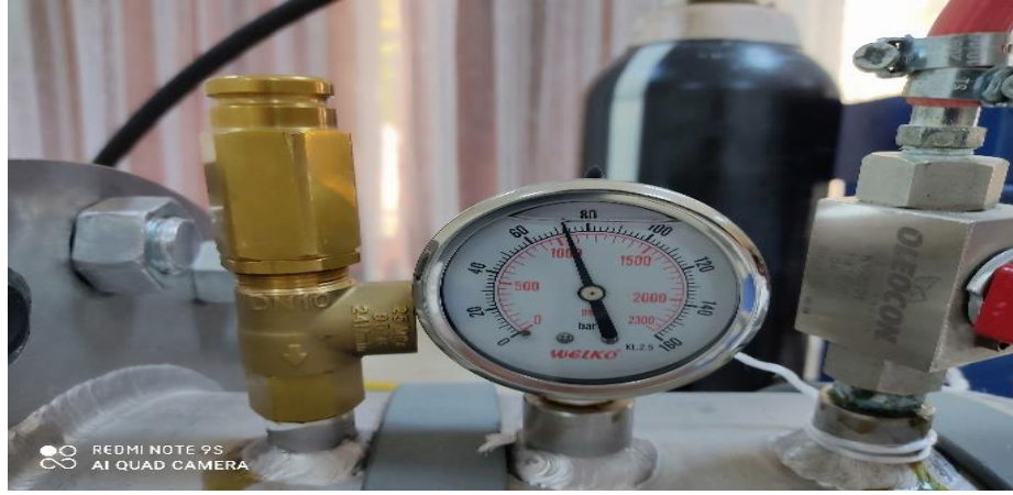
Şekil 3.24. Reaktör içerisindeki CO 2 'nin süperkritik duruma ulaşması
