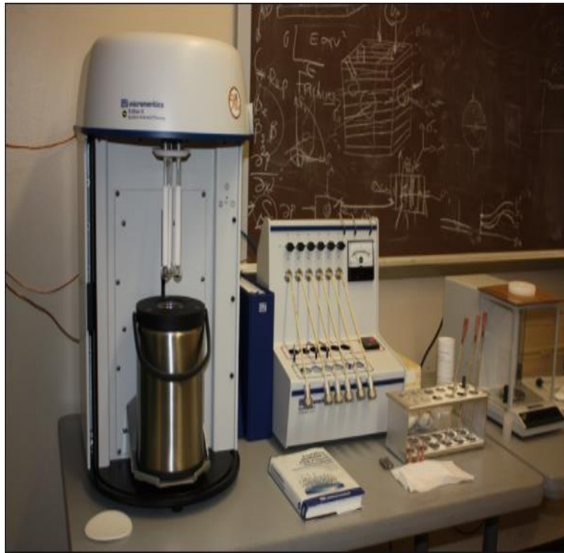
Şekil 3.31. Satıh alanı ile gözenek dağılımı ( BET Micromeritics - TriStar II Plus 3030 ) cihazı
