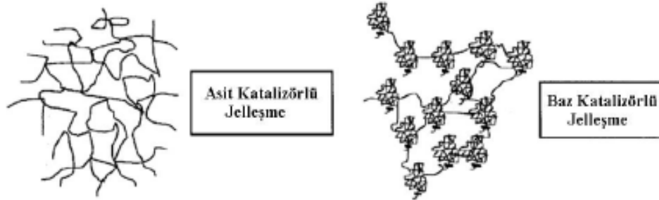
Şekil 3.6. Asit ve baz katalizörüne göre ağ yapıları (Li ve vd. 2014).
