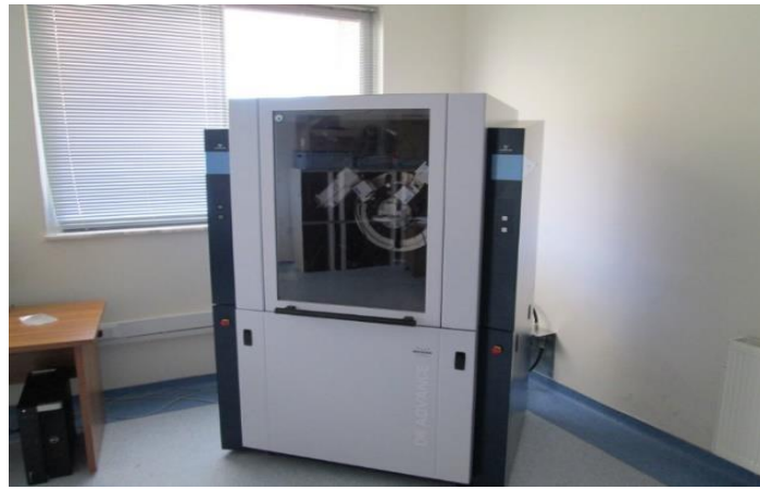
Şekil 4.3. Aerojellerin kristalografik özelliklerinin belirlenmesinde kullanılan XRD cihazı
