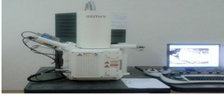
Şekil 4.1. Aerogellerin yüzey morfolojisinin belirlenmesinde kullanılan SEM cihazı
