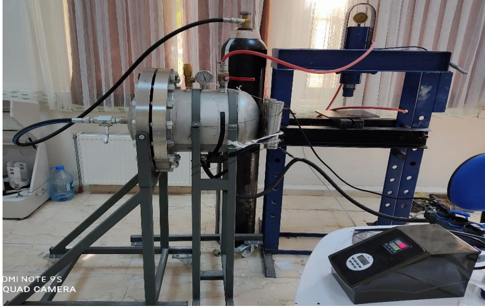
Şekil 3.23. Süper kritik kurutma için deney seti görüntüsü
