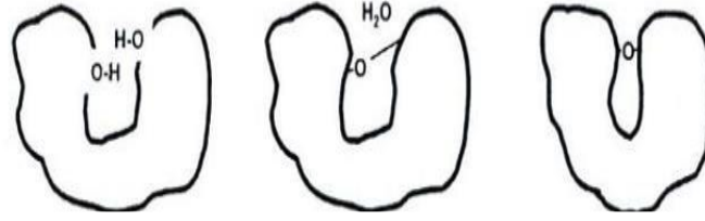
Şekil 3.9. Yaşlandırma esnasında meydana gelen çökme durumu (Baetens ve vd. 2010).
