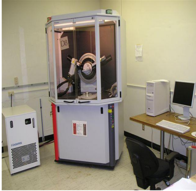
Şekil 3.32. X-ışını difraktometre ( Bruker D8 Advance ) cihazı
