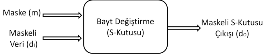
Şekil 6.8 Bayt değiştirme bloğu giriş ve çıkışı
